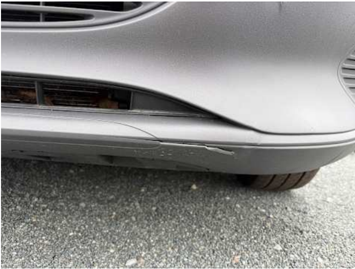
Stoßstange vorne (Riss/Bruch)
