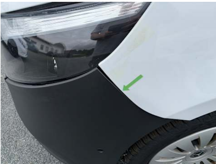
Stoßstange vorne (Spaltmaße ungenau)
