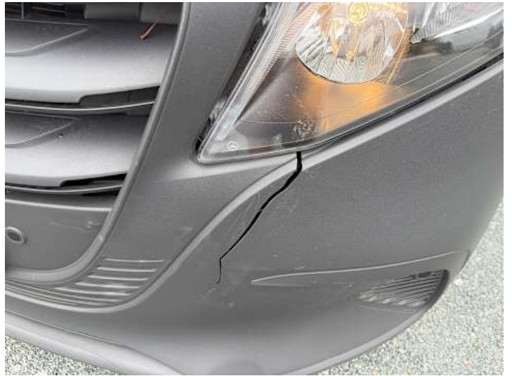
Stoßstange vorne (Riss/Bruch)
