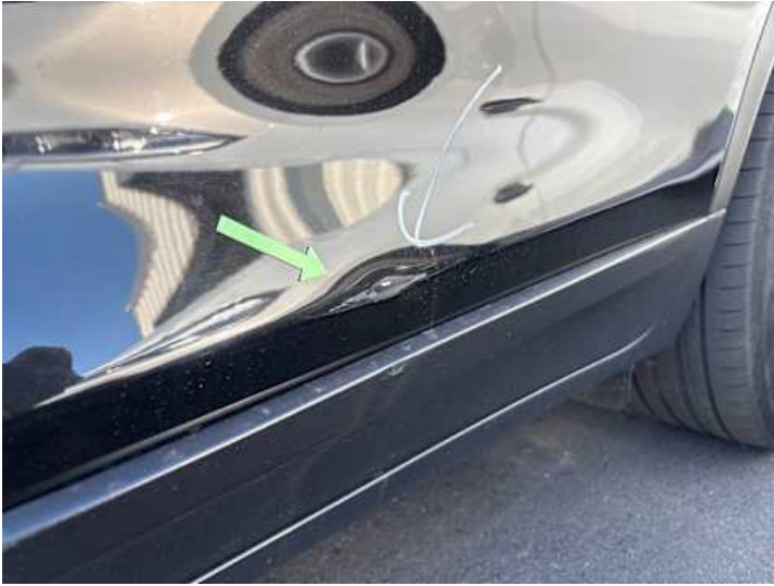
Türe hinten links (Kratzer)
