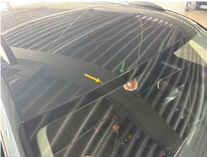
Dach (Lackschaden, Rost)
