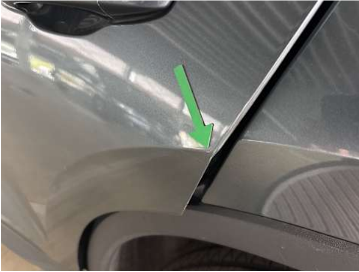
Türe hinten links (Lackschaden)
