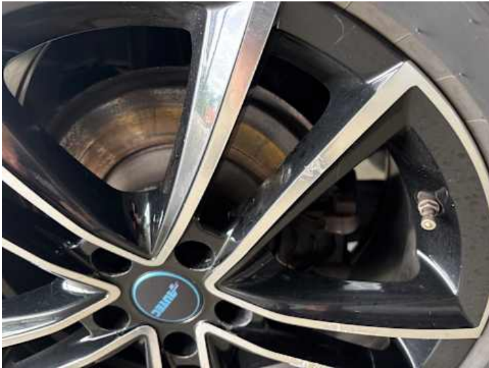
Rad (Kratzer, Anderer Schaden): Lackschaden
