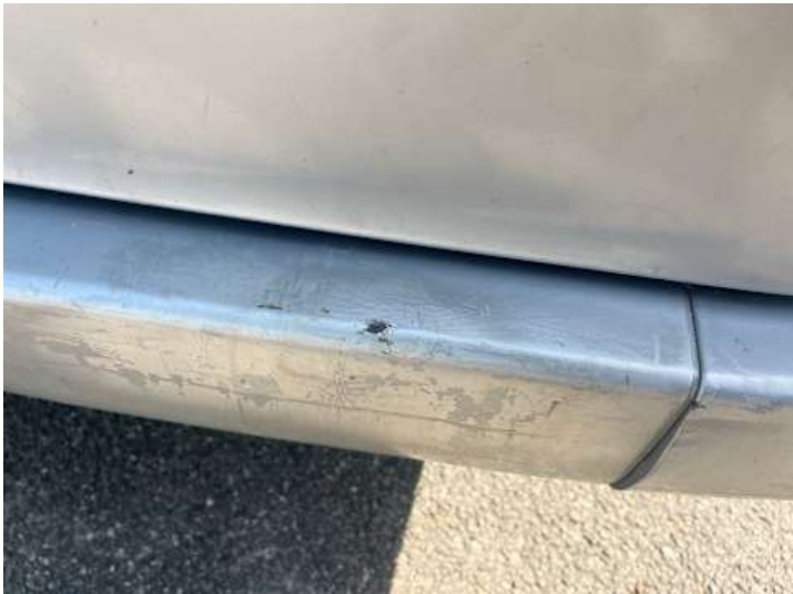
Stoßstange hinten (Verformung)
