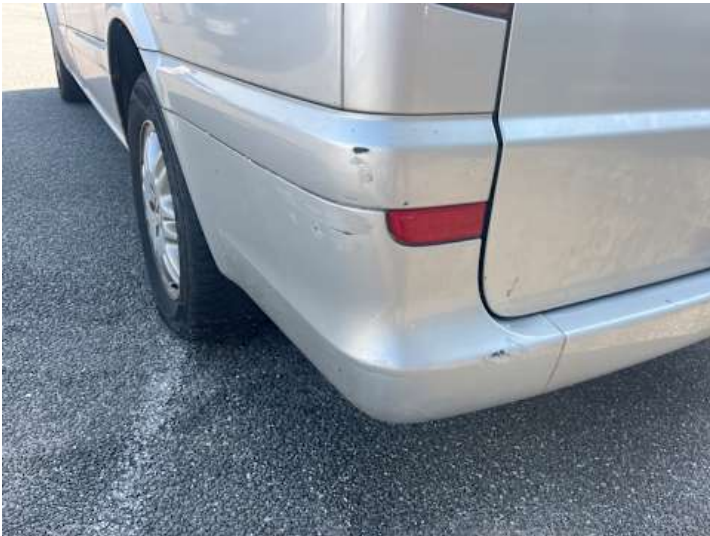
Stoßstange hinten (Kratzer, Lackschaden)
