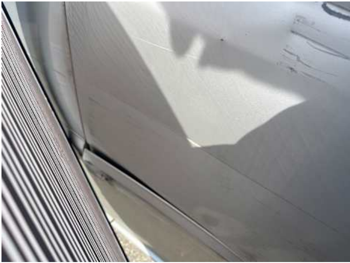
Türe hinten rechts (Verformung)
