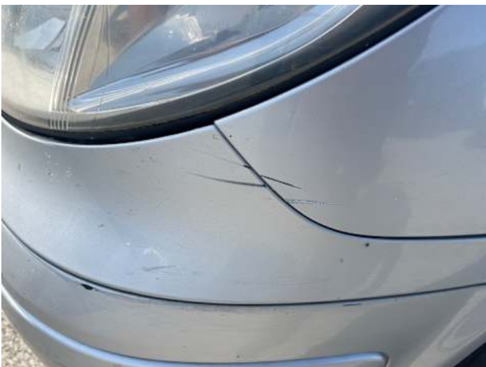
Stoßstange vorne (Kratzer, Lackschaden)
