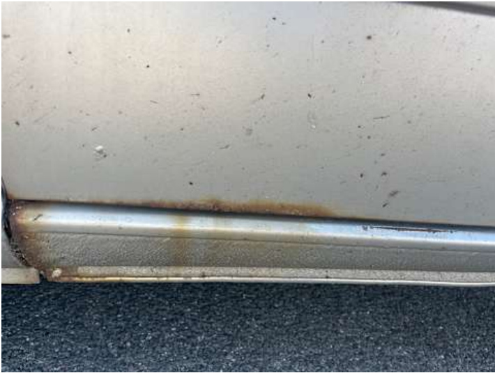
Fahrertür (Lackschaden, Rost)
