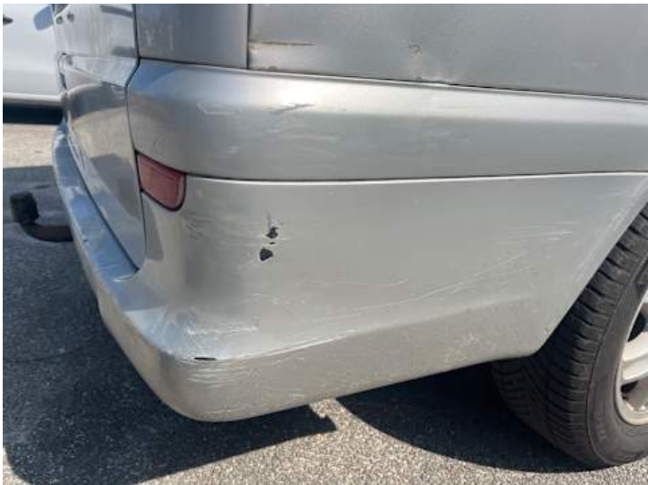
Stoßstange hinten (Kratzer, Lackschaden)
