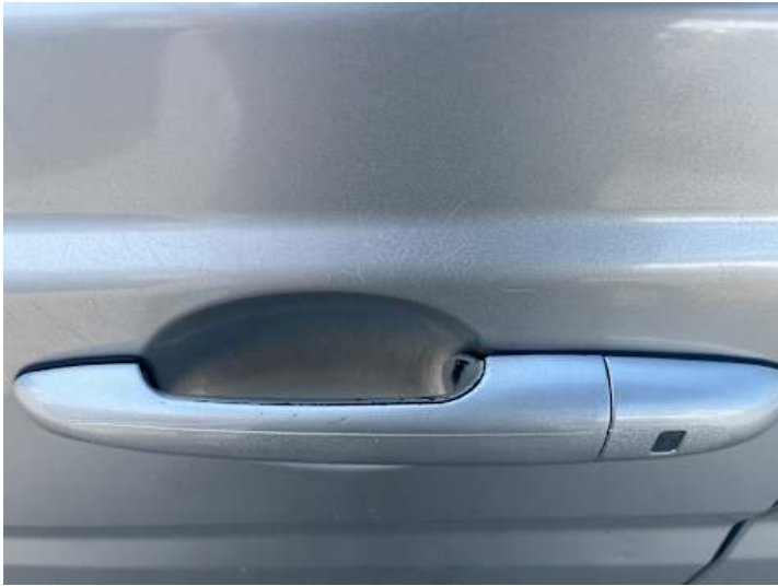
Fahrertür (Kratzer, Lackschaden)
