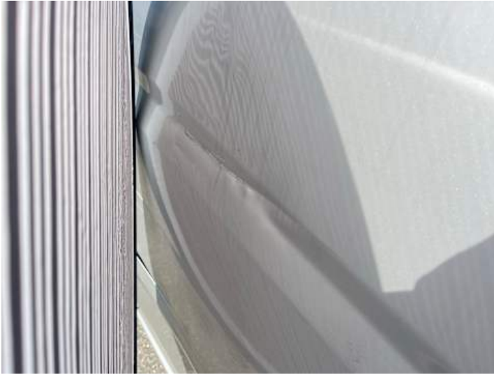
Türe hinten rechts (Verformung)
