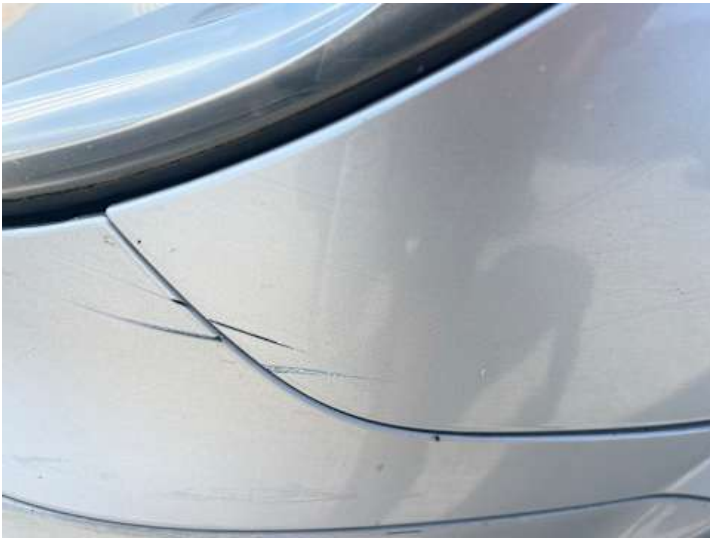
Kotflügel vorne links (Kratzer, Lackschaden)
