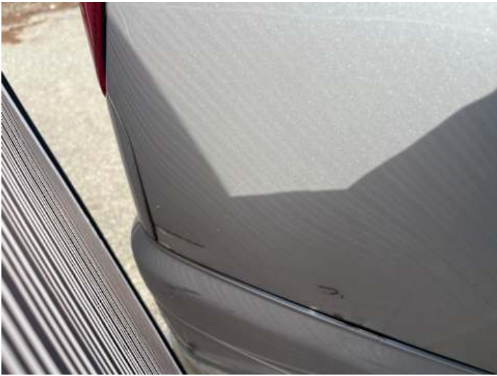
Seitenteil hinten rechts (Verformung)
