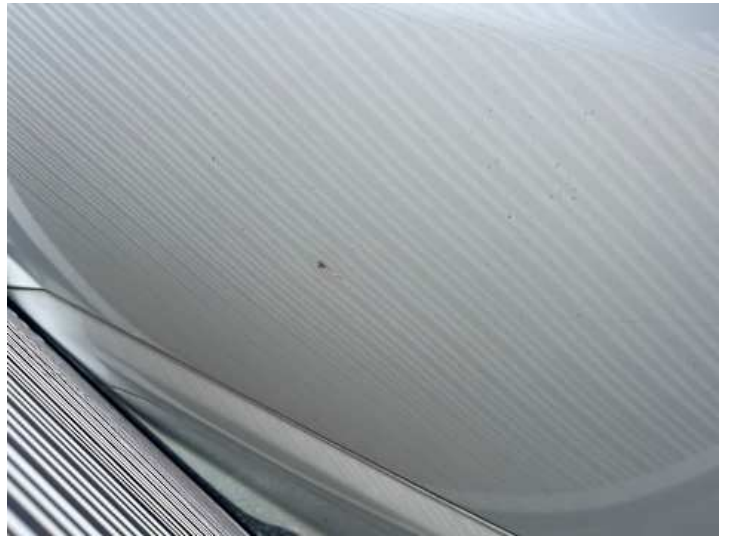
Seitenteil hinten links (Delle)
