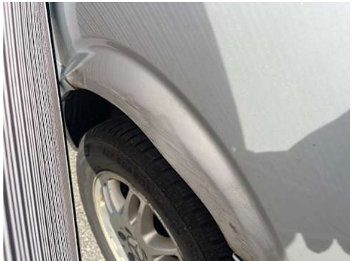
Seitenteil hinten rechts (Verformung)
