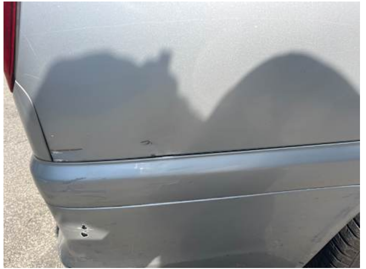
Seitenteil hinten rechts (Kratzer, Lackschaden)
