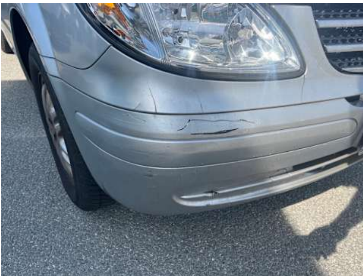
Stoßstange vorne (Kratzer, Lackschaden)
