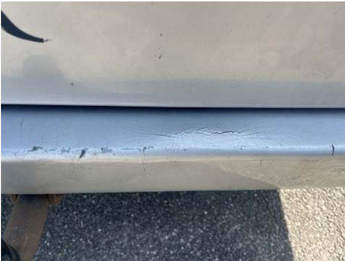
Stoßstange hinten (Verformung)
