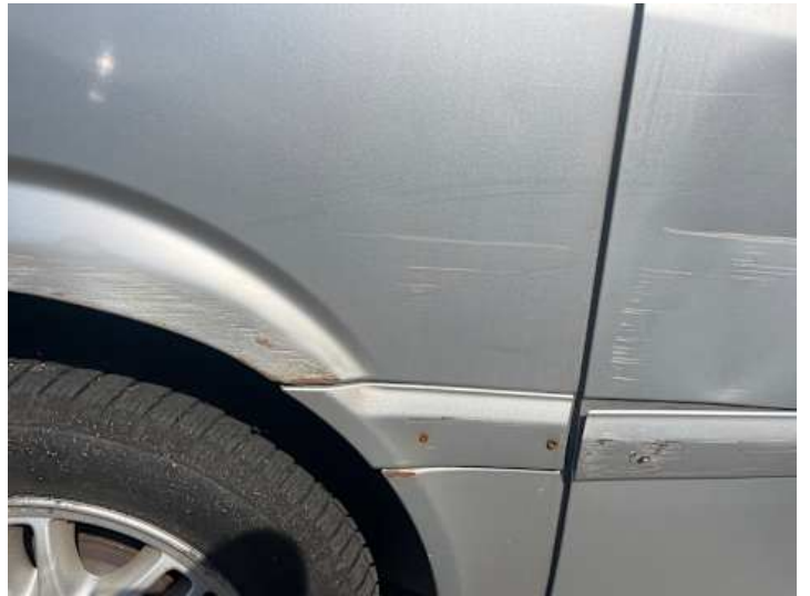
Seitenteil hinten rechts (Kratzer, Lackschaden)
