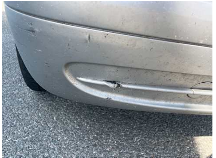
Stoßstange vorne (Verformung)
