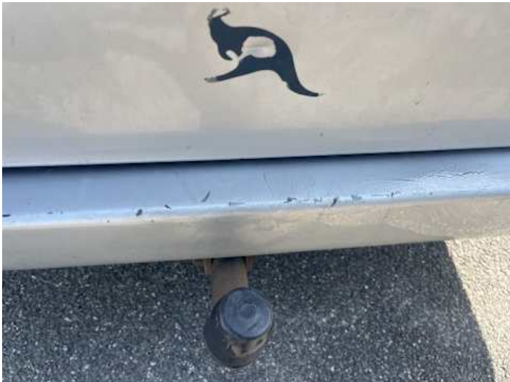
Stoßstange hinten (Kratzer, Lackschaden)
