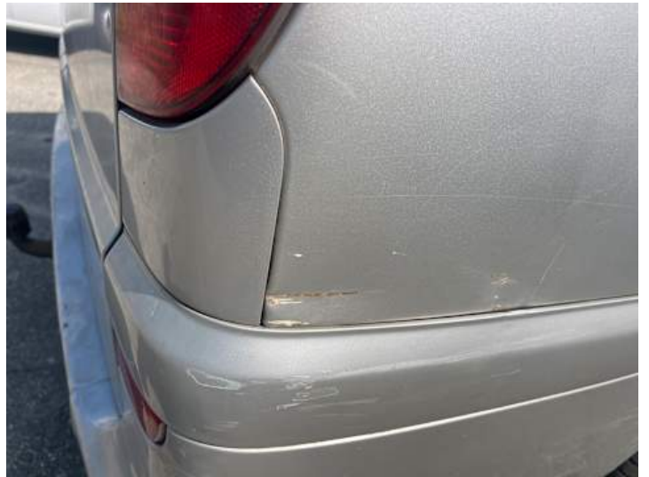
Seitenteil hinten rechts (Lackschaden, Rost)
