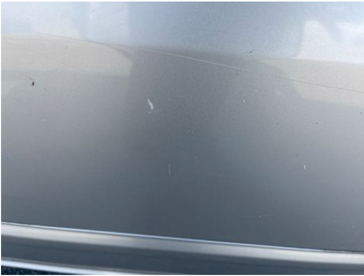
Seitenteil hinten links (Kratzer, Lackschaden)
