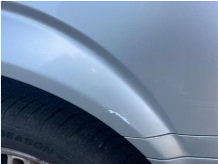
Kotflügel vorne rechts (Kratzer, Lackschaden)
