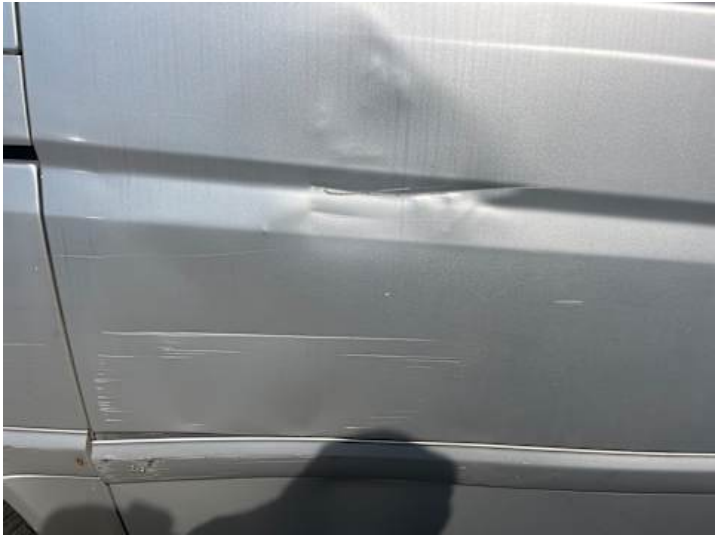
Türe hinten rechts (Kratzer, Lackschaden)
