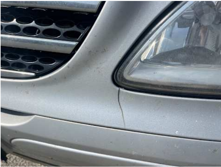
Stoßstange vorne (Riss/Bruch)
