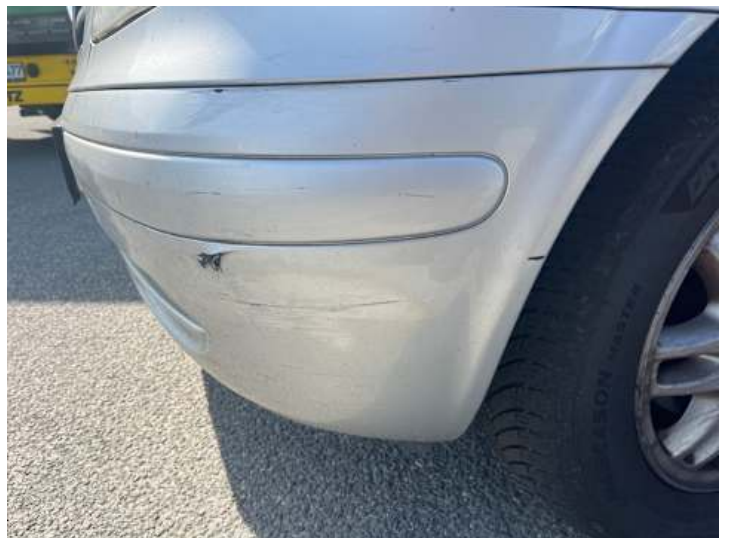
Stoßstange vorne (Kratzer, Lackschaden)
