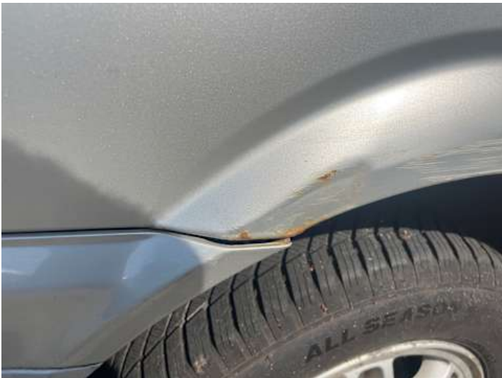
Seitenteil hinten rechts (Lackschaden, Rost)
