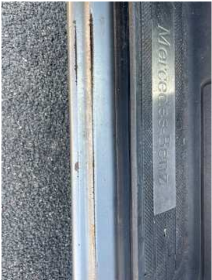
Fahrertür (Lackschaden, Rost)
