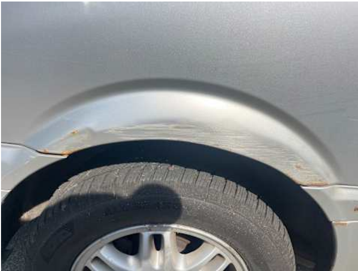
Seitenteil hinten rechts (Kratzer, Lackschaden)
