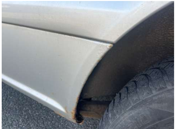
Seitenteil hinten links (Lackschaden, Rost)
