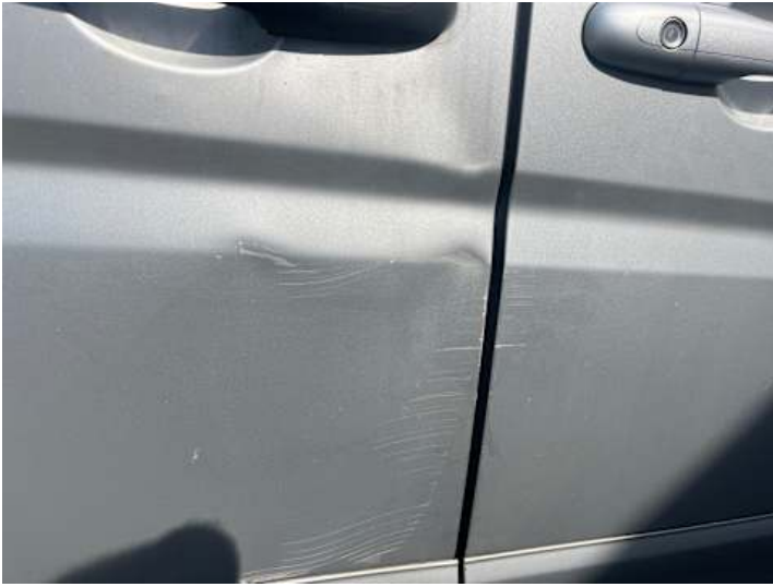
Türe hinten rechts (Kratzer, Lackschaden)
