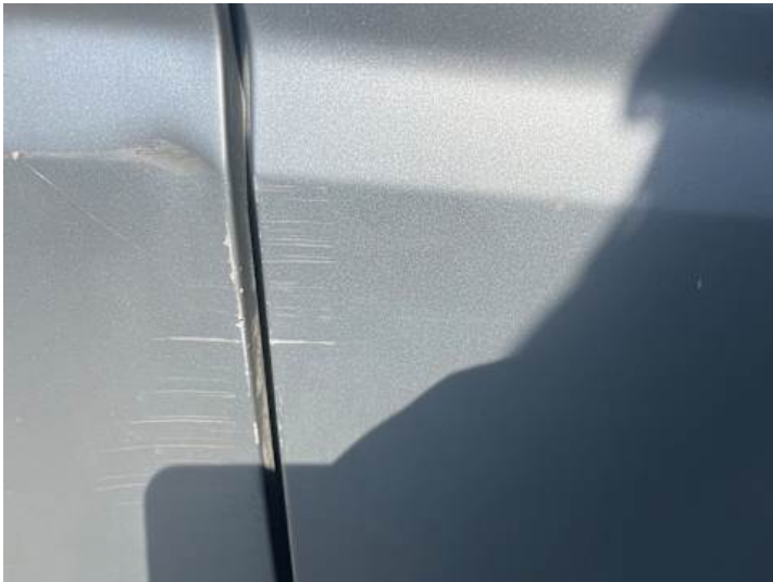
Beifahrertür (Kratzer, Lackschaden)
