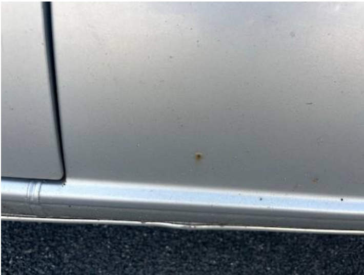
Seitenteil hinten links (Lackschaden)
