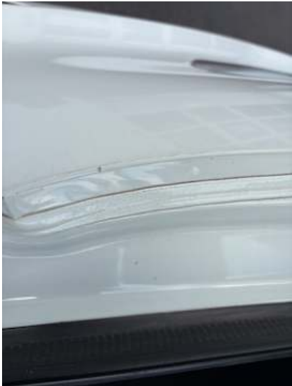
Seitenteil hinten links (Steinschlag)
