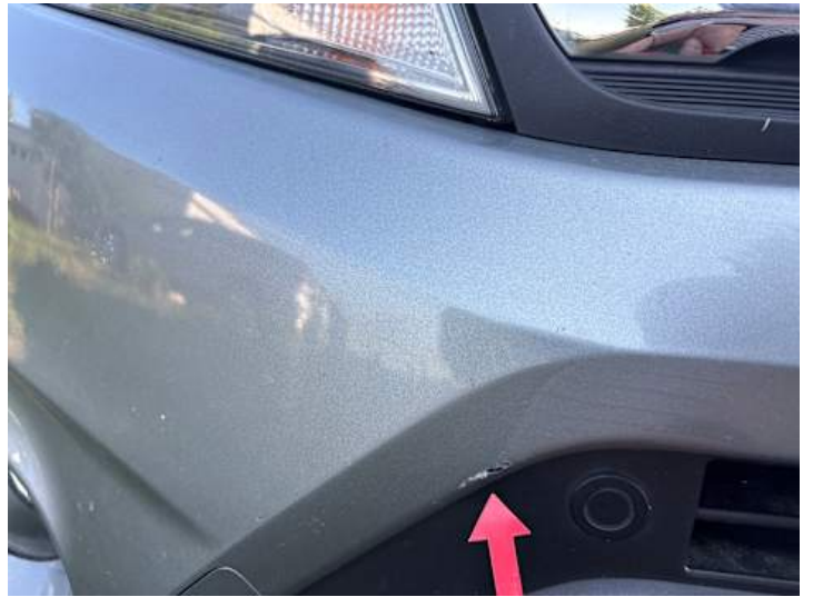
Stoßstange vorne (Kratzer, Unsachgemäß instand gesetzt)
