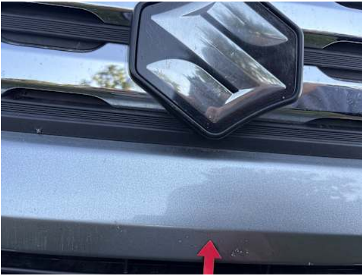
Stoßstange vorne (Kratzer, Unsachgemäß instand gesetzt)
