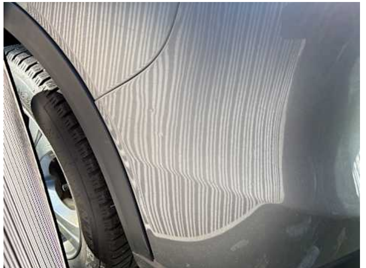
Stoßstange hinten (Kratzer, Lackschaden, Unsachgemäß instand gesetzt)
