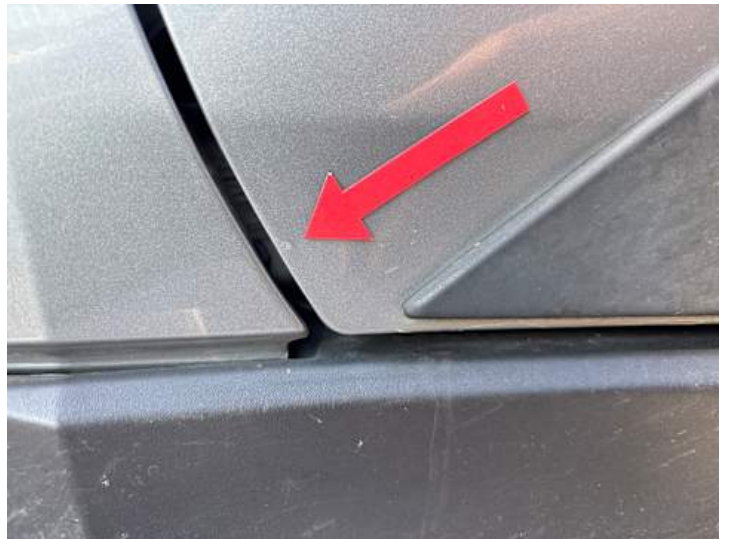
Fahrtür (Lackschaden, Unsachgemäß instand gesetzt)
