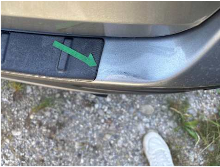
Stoßstange hinten (Kratzer, Lackschaden, Unsachgemäß instand gesetzt)
