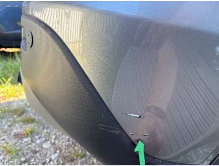
Stoßstange hinten (Kratzer, Lackschaden, Unsachgemäß instand gesetzt)
