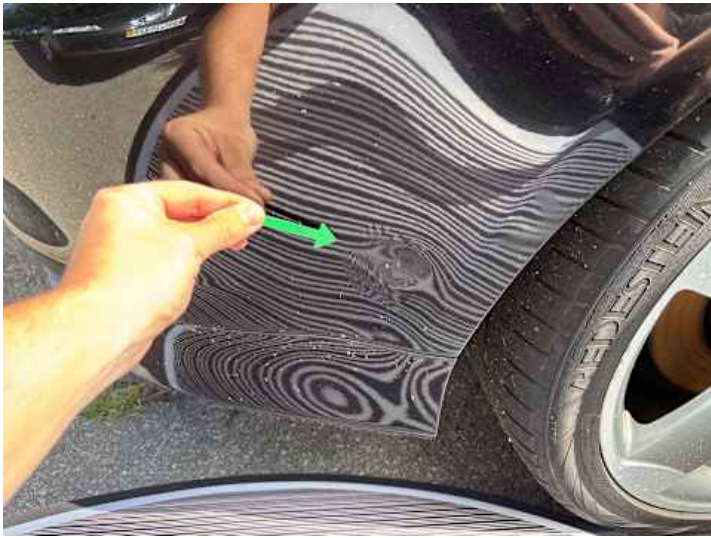
Stoßstange hinten (Verformung, Riss/Bruch, Kratzer, Lackschaden, Unsachgemäß instand gesetzt)
