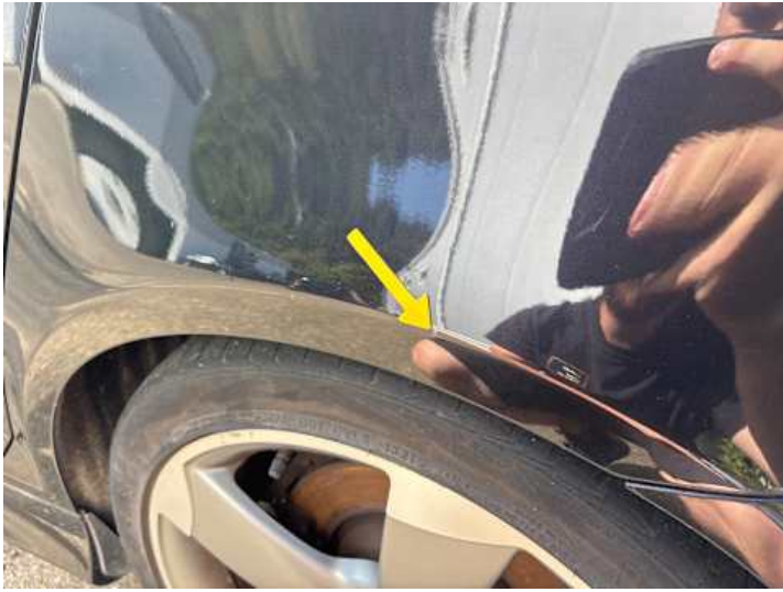
Seitenteil hinten links (Kratzer, Lackschaden, Rost)
