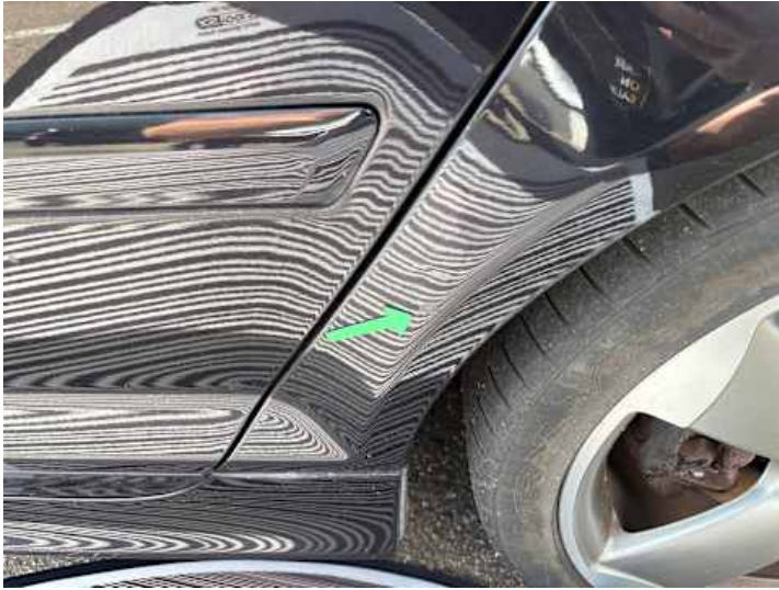
Seitenteil hinten links (Kratzer, Lackschaden, Rost)
