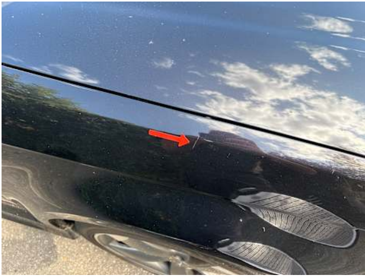
Kotflügel vorne rechts (Kratzer, Lackschaden)
