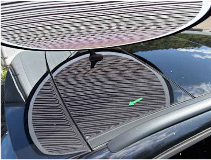
Dach (Lackschaden, Unsachgemäß instand gesetzt)
