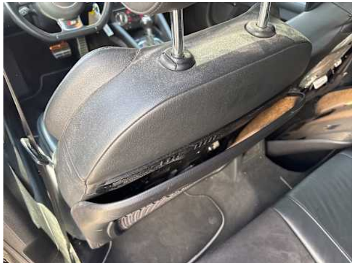
Innenraum (Diverse Schäden, Riss/Bruch)
