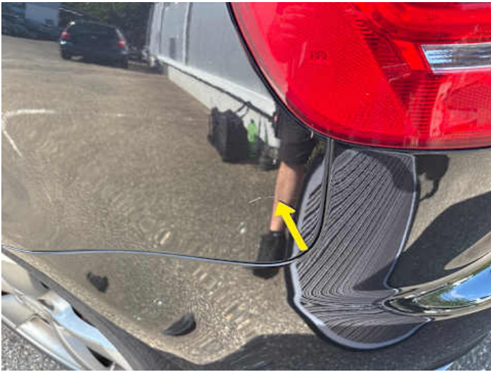
Seitenteil hinten links (Kratzer, Lackschaden, Rost)
