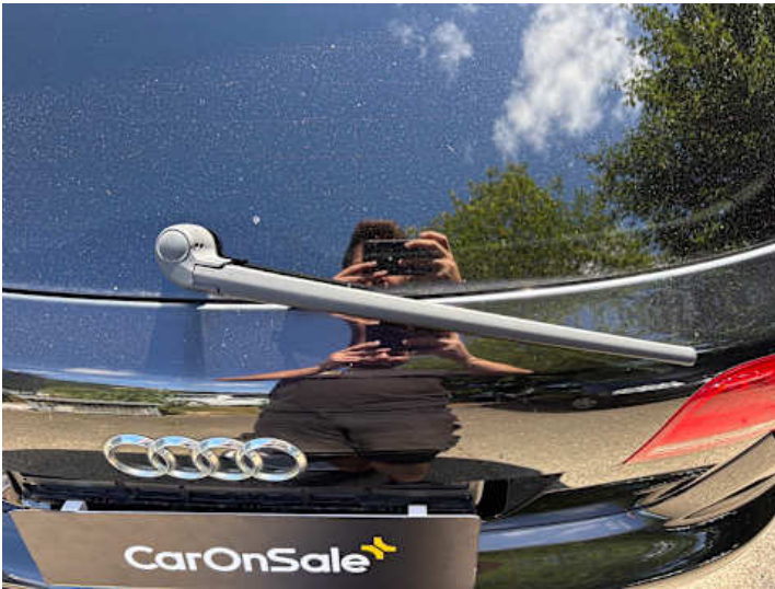
Rückscheibe (Anderer Schaden): Heckscheibenwischer unsachgemäß montiert
