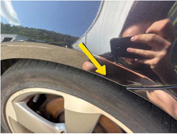
Seitenteil hinten links (Kratzer, Lackschaden, Rost)
