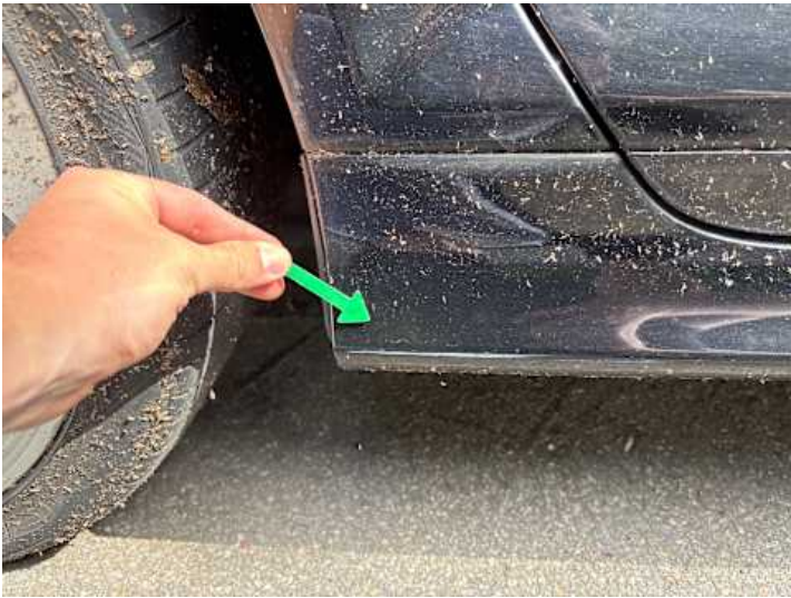
Schweller rechts (Kratzer, Lackschaden)
