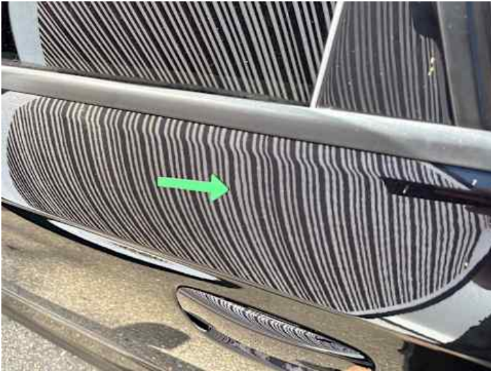
Türe hinten links (Delle)
