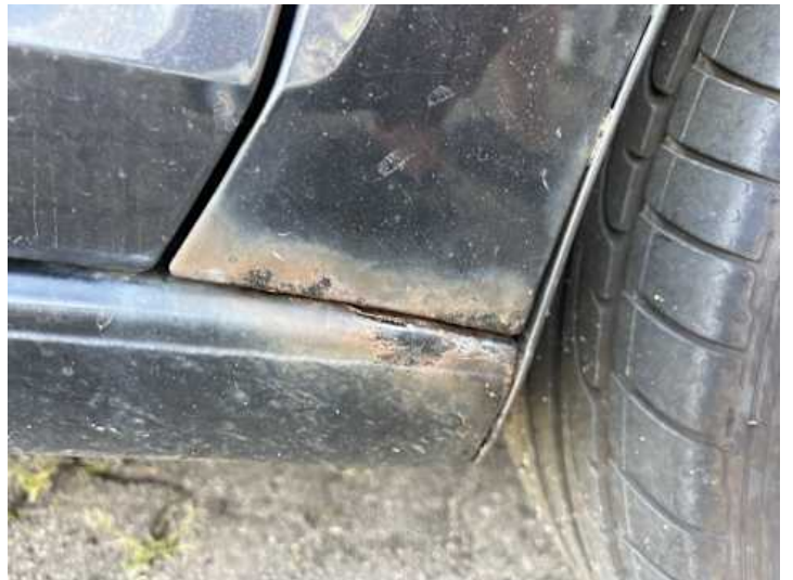
Schweller rechts (Rost)
