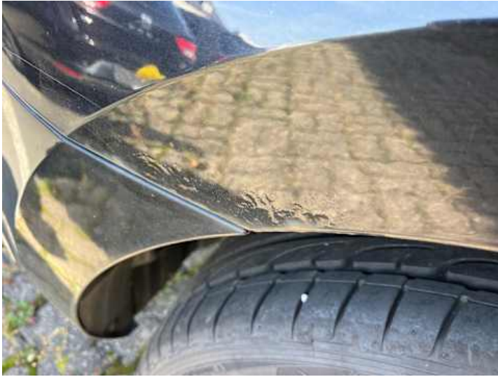
Seitenteil hinten rechts (Rost)
