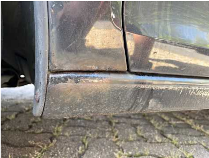
Schweller links (Rost)
