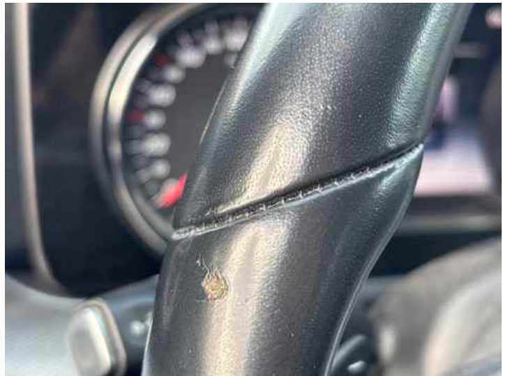
Innenraum (Verschleiß, Kratzer)
