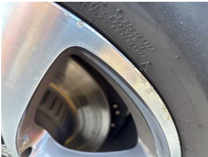
Rad (Kratzer, Rost)
