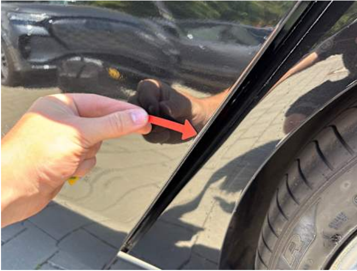
Türe hinten links (Kratzer, Lackschaden)
