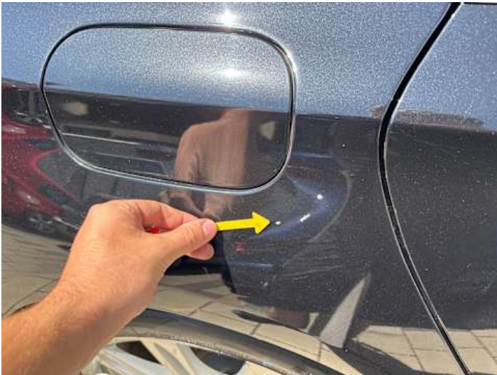
Seitenteil hinten rechts (Lackschaden, Kratzer)
