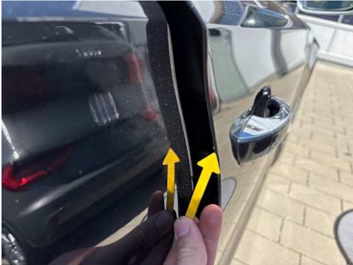
Beifahrtür (Lackschaden, Kratzer)
