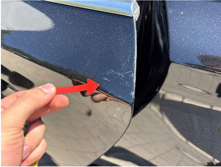
Türe hinten links (Kratzer, Lackschaden)
