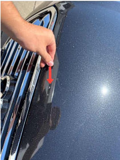
Motorhaube (Steinschlag, Kratzer)
