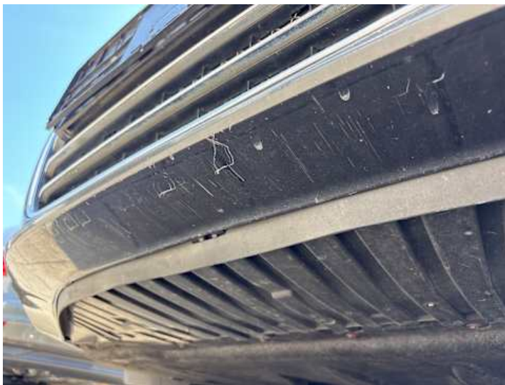
Stoßstange vorne (Lackschaden, Kratzer, Steinschlag)
