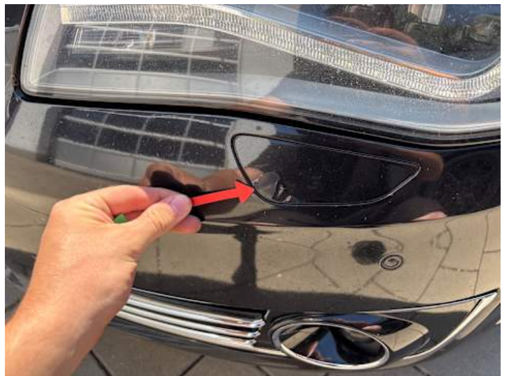
Stoßstange vorne (Lackschaden, Kratzer, Steinschlag)
