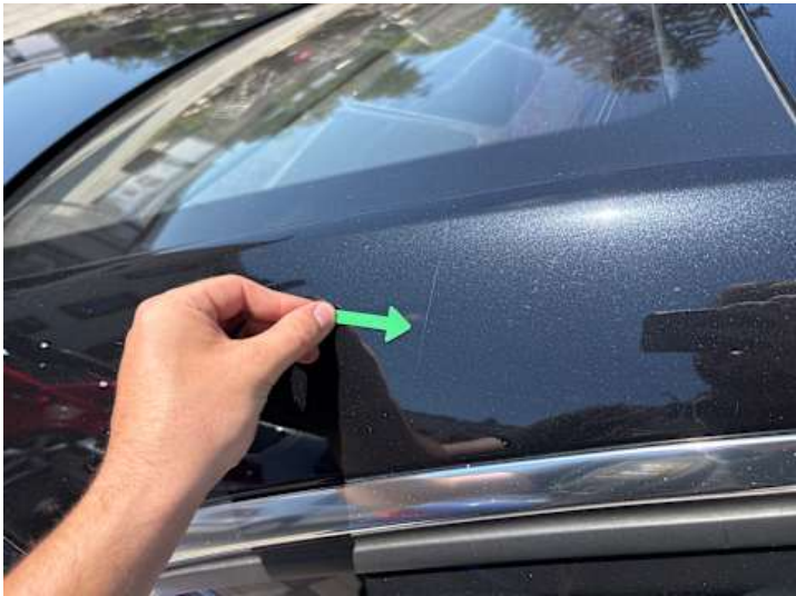
Seitenteil hinten rechts (Lackschaden, Kratzer)
