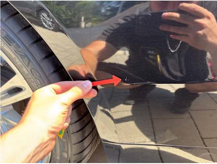
Seitenteil hinten links (Kratzer, Lackschaden, Delle)
