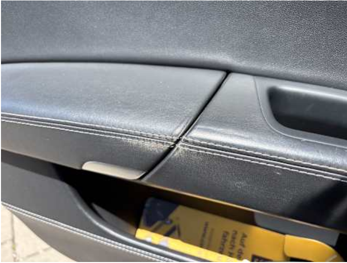
Innenraum (Verschleiß, Verschmutzung)
