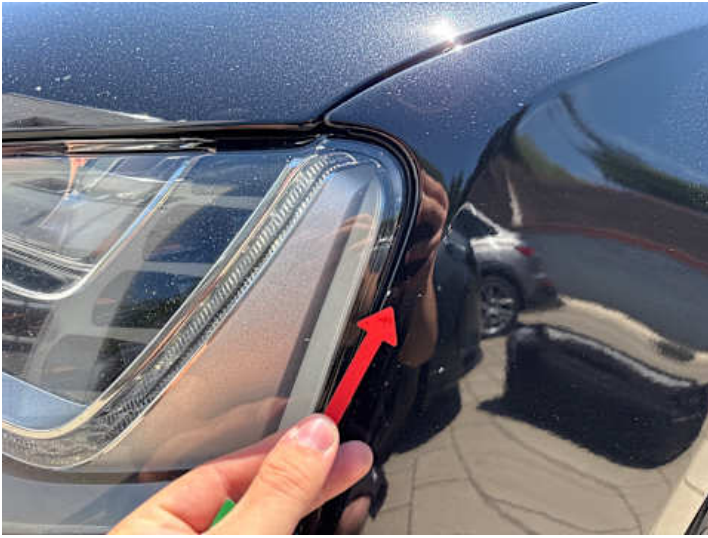
Kotflügel vorne links (Kratzer, Lackschaden, Steinschlag)
