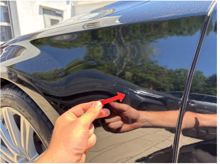
Kotflügel vorne links (Kratzer, Lackschaden, Steinschlag)
