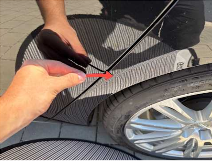
Seitenteil hinten links (Kratzer, Lackschaden, Delle)
