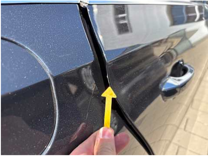
Türe hinten rechts (Lackschaden)
