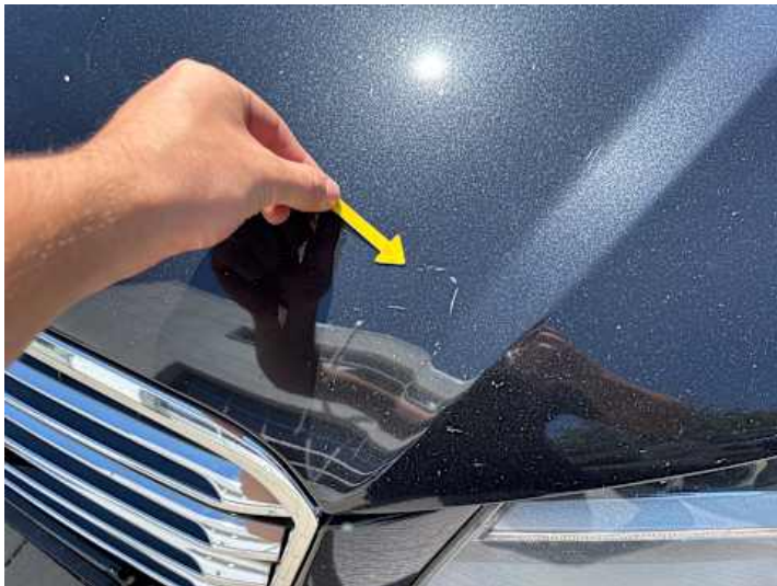
Motorhaube (Steinschlag, Kratzer)
