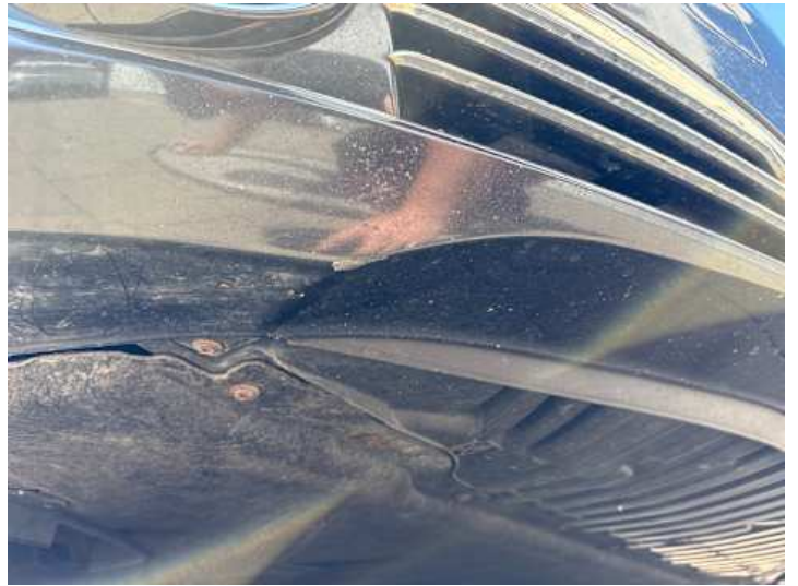
Stoßstange vorne (Lackschaden, Kratzer, Steinschlag)
