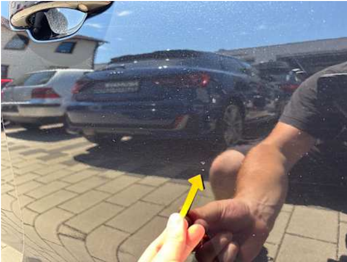
Beifahrtür (Lackschaden, Kratzer)
