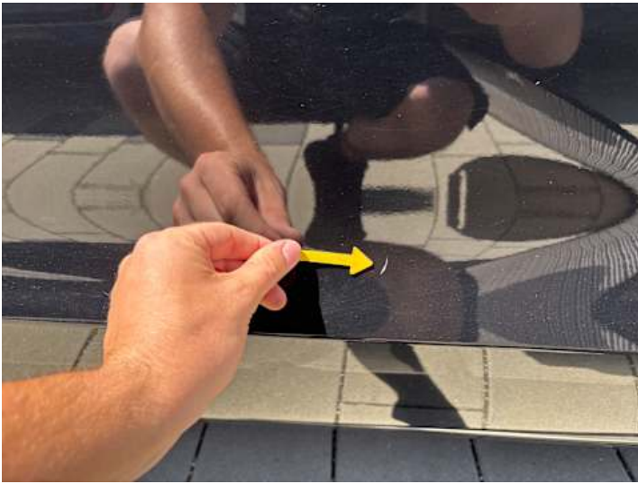
Beifahrertür (Lackschaden, Kratzer)
