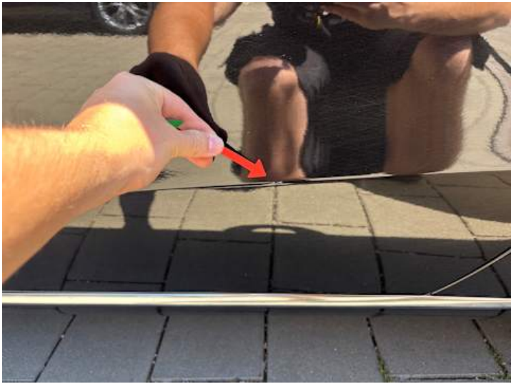
Türe hinten links (Kratzer, Lackschaden)
