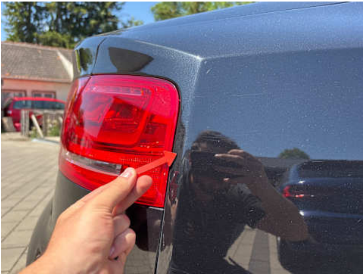
Seitenteil hinten rechts (Lackschaden, Kratzer)
