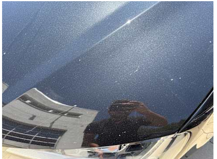
Motorhaube (Steinschlag, Kratzer)
