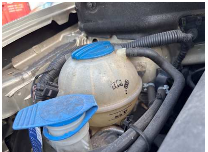
Motorhaube (Anderer Schaden): Kühlmittelausgleichsbehälter
