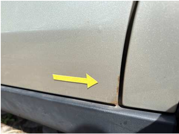
Türe hinten links (Rost)
