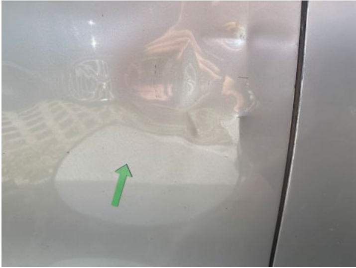
Türe hinten rechts (Verformung, Kratzer)
