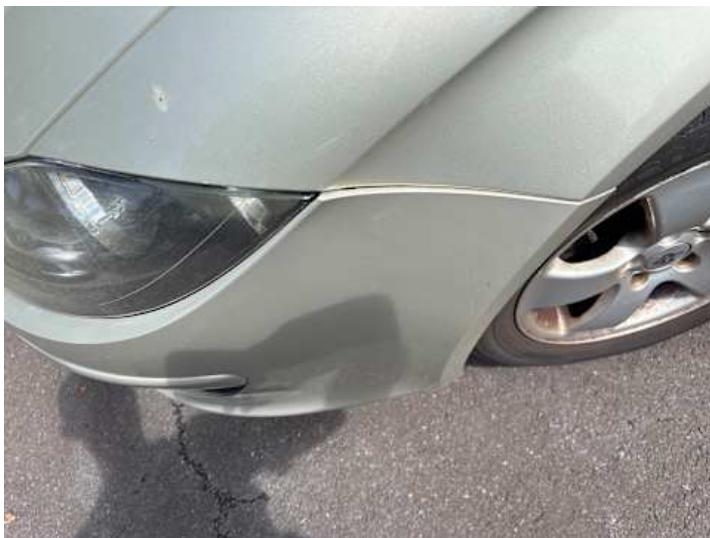
Stoßstange vorne (Kratzer, Spaltmaße ungenau)
