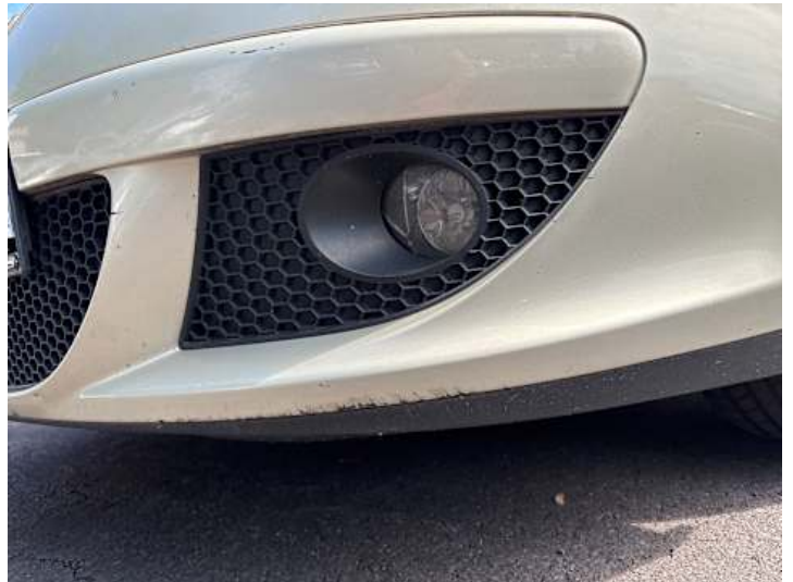
Stoßstange vorne (Kratzer, Spaltmaße ungenau)
