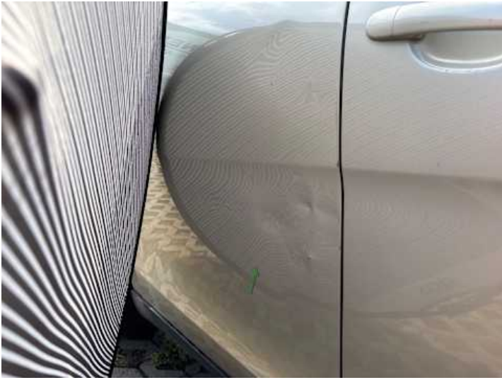
Türe hinten rechts (Verformung, Kratzer)
