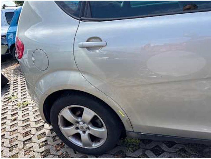
Seitenteil hinten rechts (Unsachgemäß instand gesetzt)
