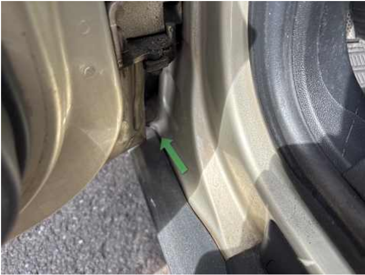
Schweller links (Rost)
