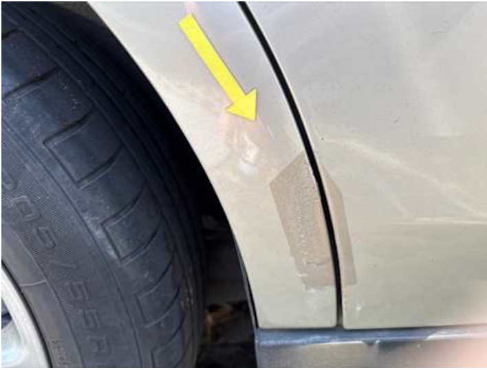
Seitenteil hinten rechts (Unsachgemäß instand gesetzt)
