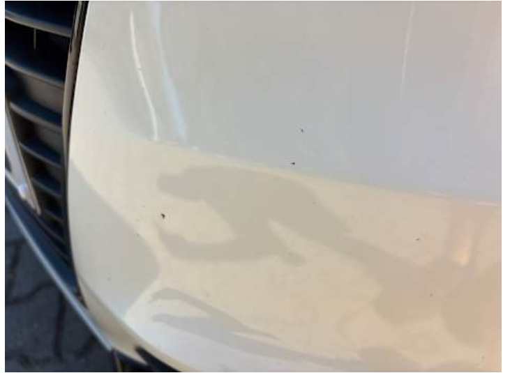
Stoßstange vorne (Lackschaden, Steinschlag)
