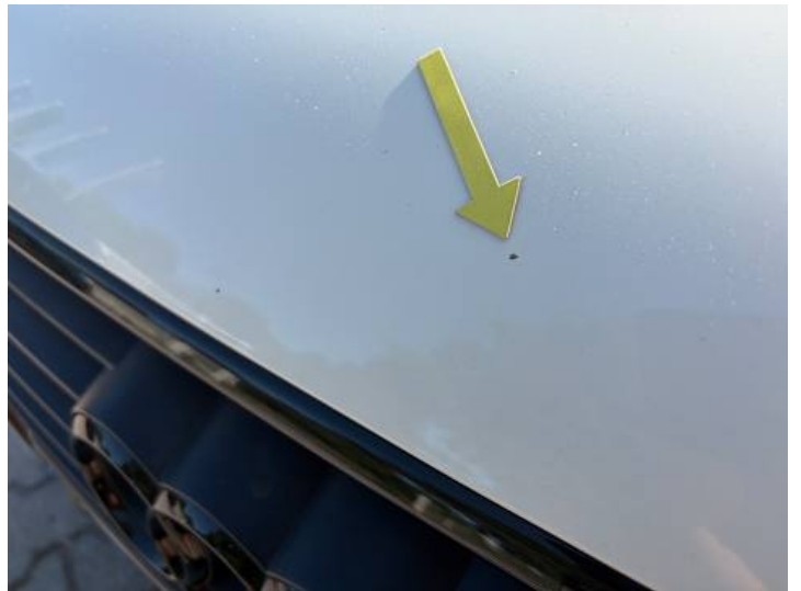
Motorhaube (Lackschaden, Steinschlag, Rost)
