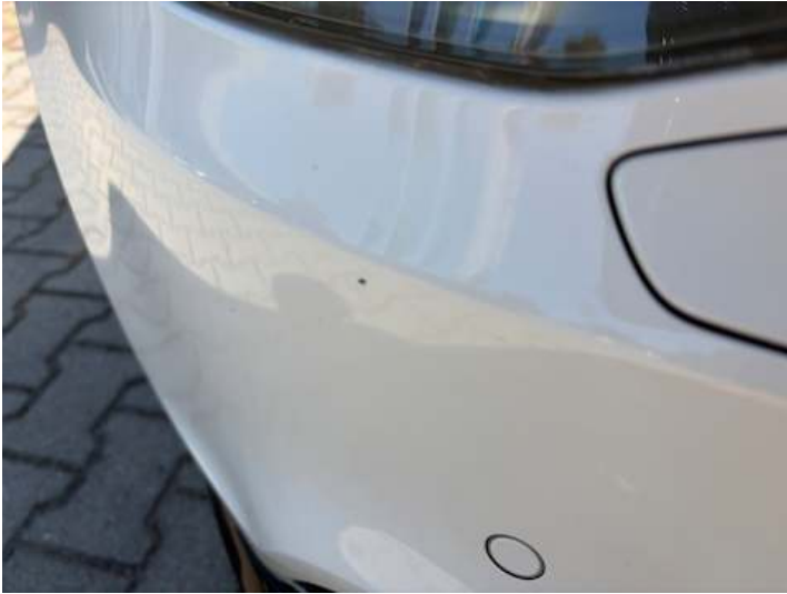
Stoßstange vorne (Lackschaden, Steinschlag)
