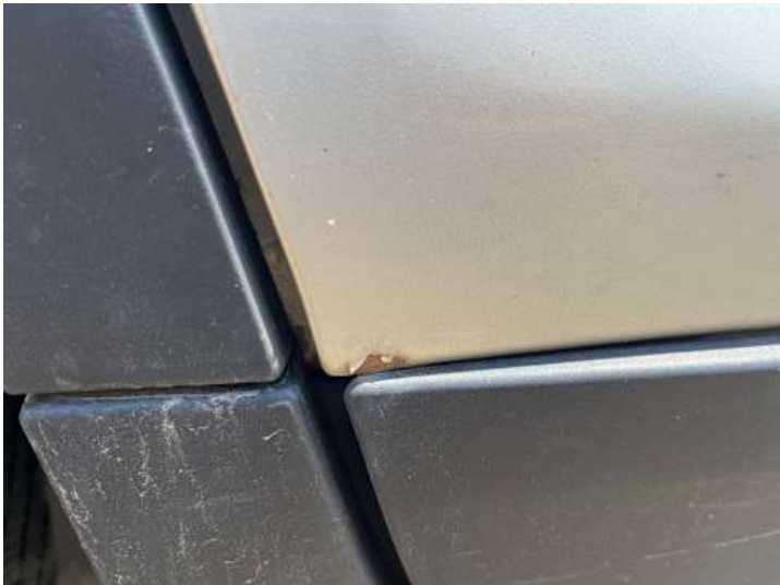
Türe hinten rechts (Rost)
