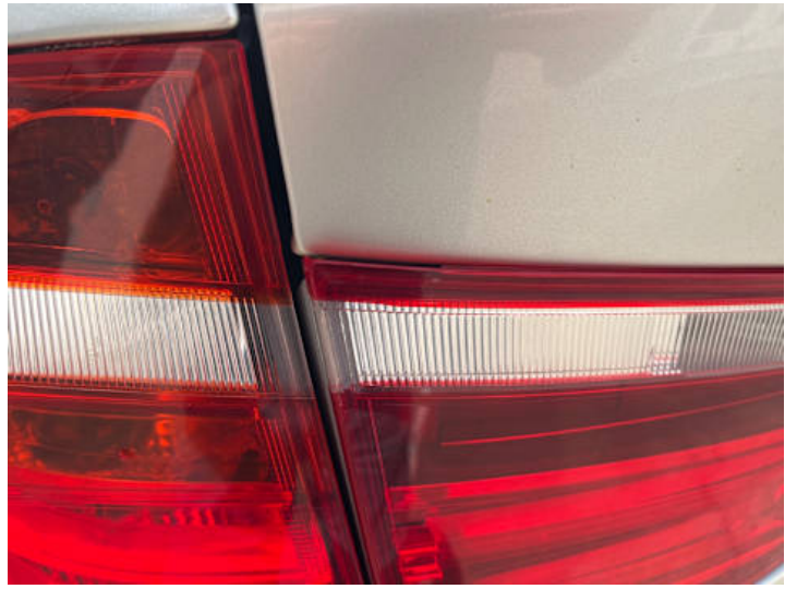
Rücklicht (links) (Anderer Schaden): Unsachgemäß verbaut
