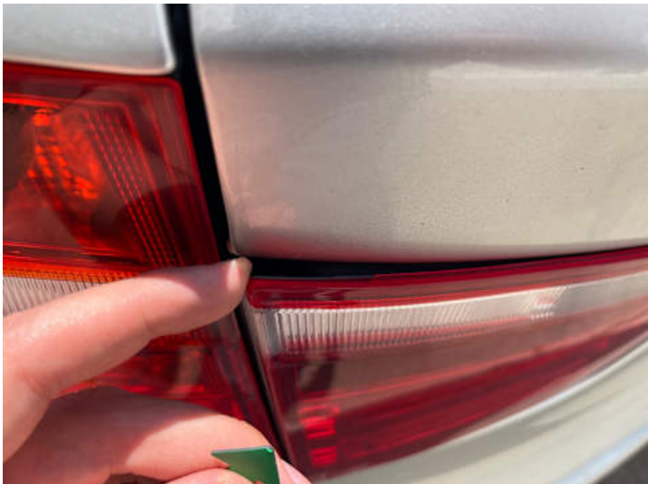
Rücklicht (links) (Anderer Schaden): Unsachgemäß verbaut
