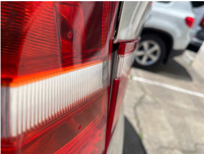
Rücklicht (links) (Anderer Schaden): Unsachgemäß verbaut
