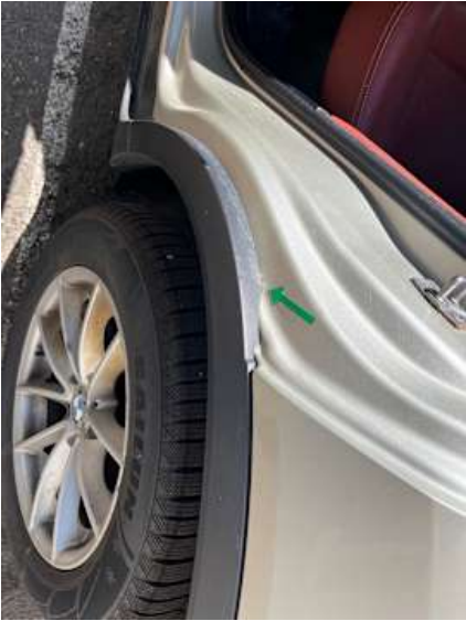
Seitenteil hinten links (Rost)
