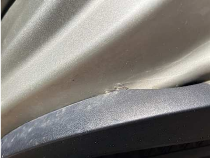
Seitenteil hinten links (Rost)
