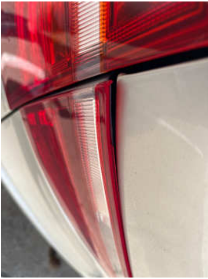
Rücklicht (links) (Anderer Schaden): Unsachgemäß verbaut
