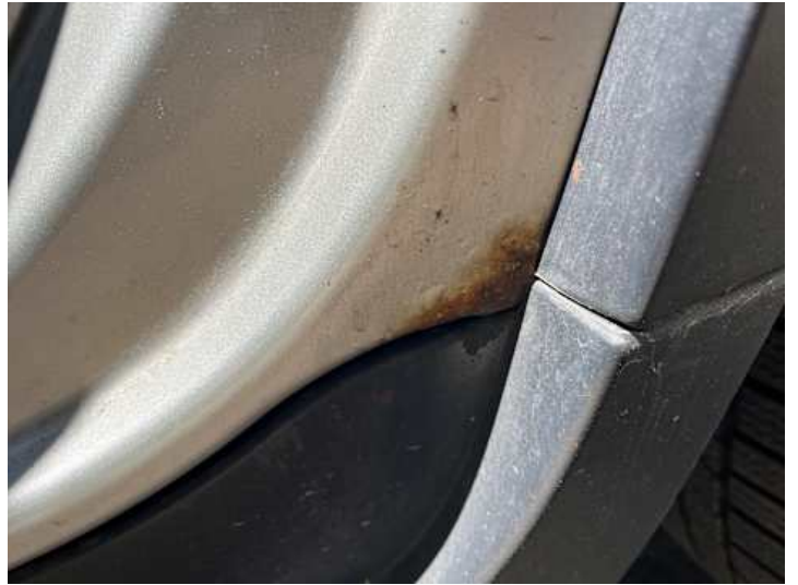
Schweller links (Rost)
