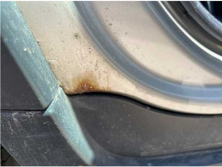
Schweller rechts (Rost)
