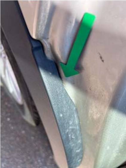
Seitenteil hinten rechts (Rost)
