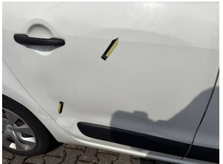
Türe hinten rechts (Verformung, Delle)
