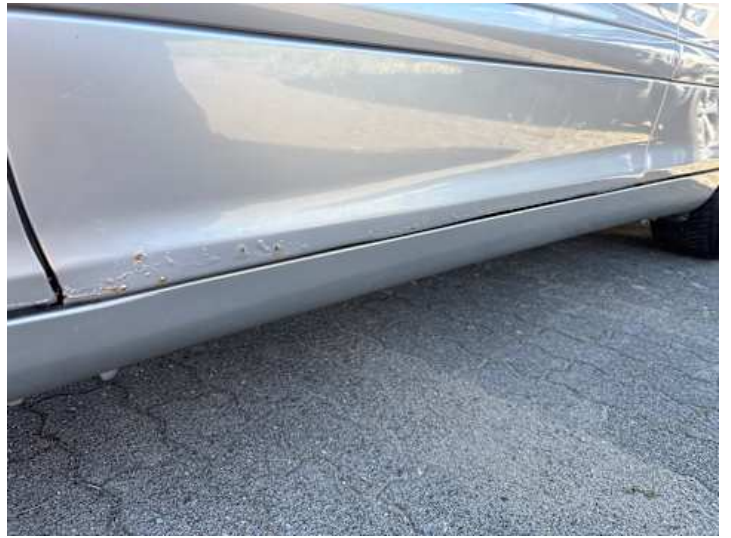
Fahrtür (Kratzer, Rost)
