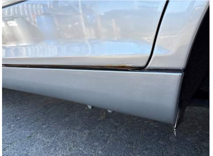
Türe hinten links (Rost)
