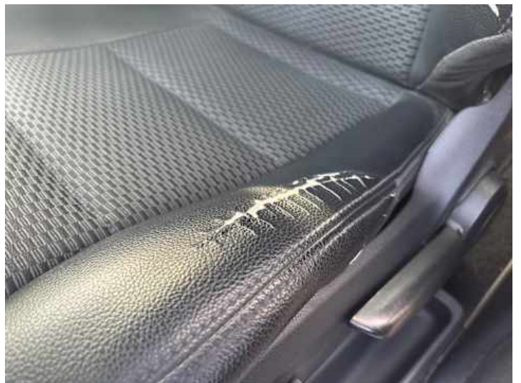
Innenraum (Riss/Bruch, Verschleiß)
