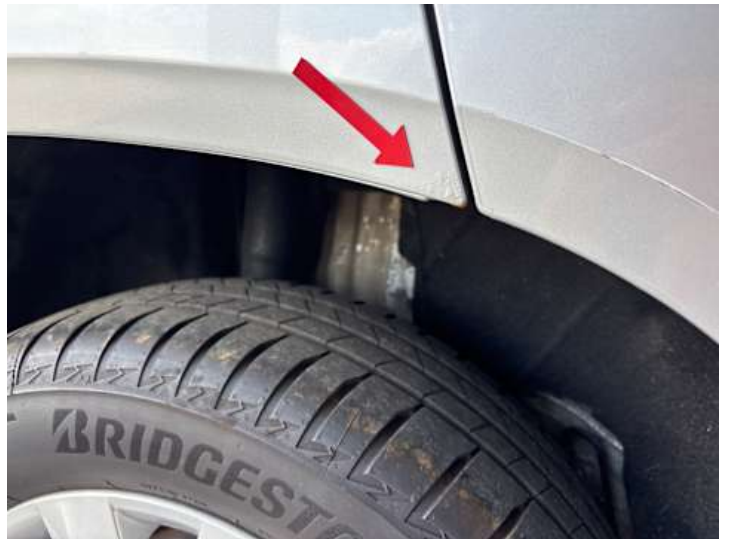
Seitenteil hinten rechts (Rost)
