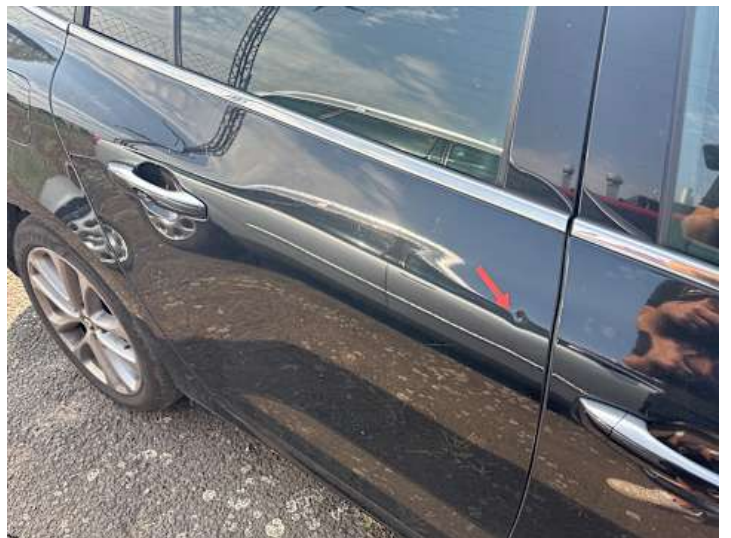
Türe hinten rechts (Delle)
