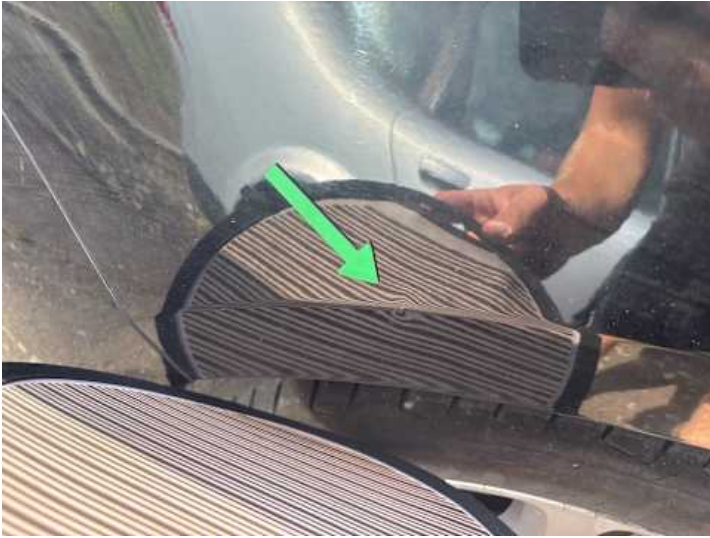
Seitenteil hinten rechts (Delle)
