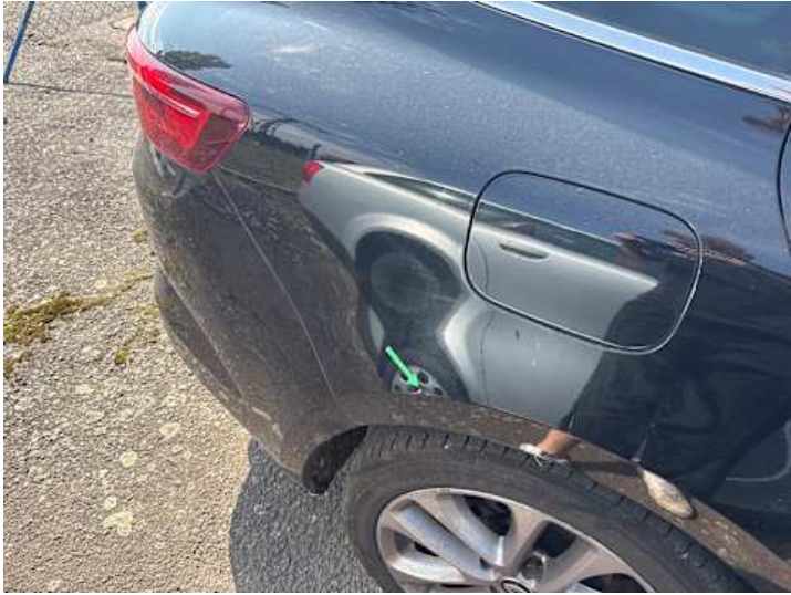
Seitenteil hinten rechts (Delle)
