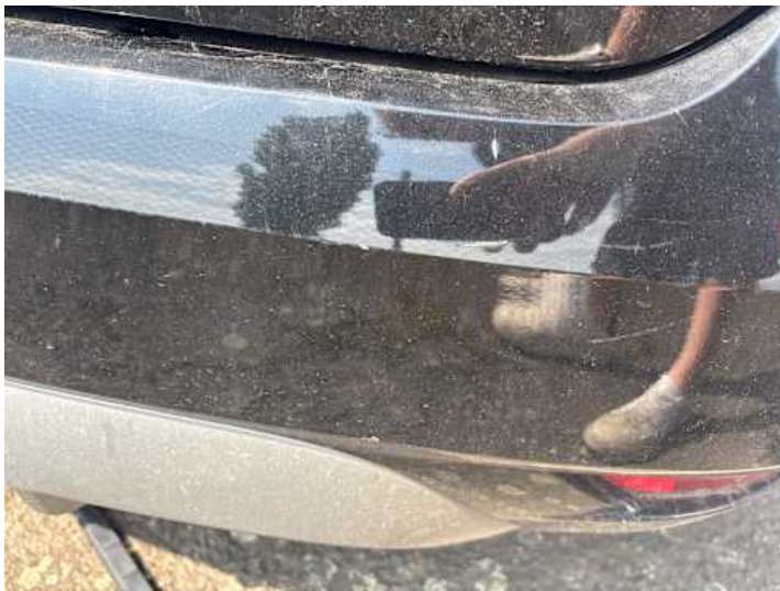
Stoßstange hinten (Kratzer, Lackschaden)
