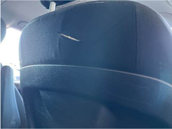
Innenraum (Riss/Bruch, Kratzer)
