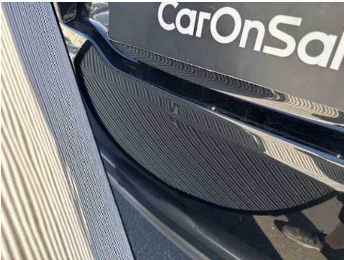
Heckklappe (Verformung, Kratzer)
