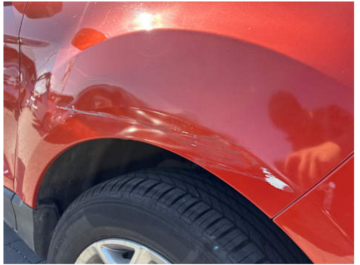
Kotflügel vorne rechts (Verformung, Lackschaden)
