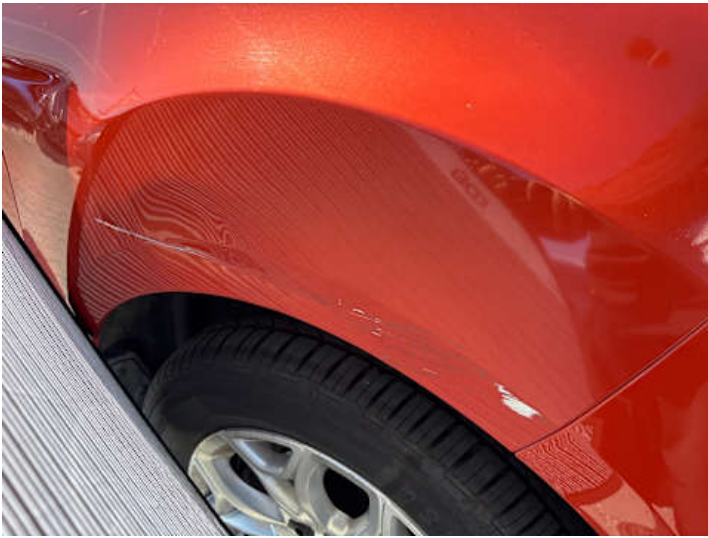
Kotflügel vorne rechts (Verformung, Lackschaden)
