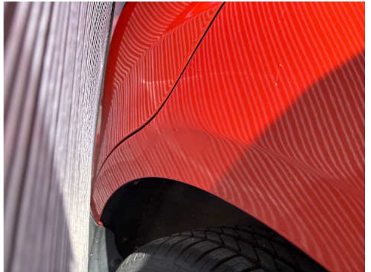
Seitenteil hinten links (Verformung)
