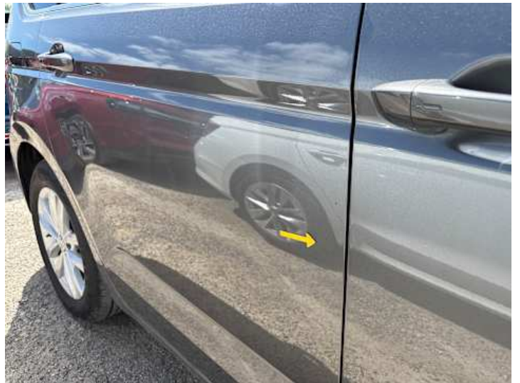
Türe hinten rechts (Delle)
