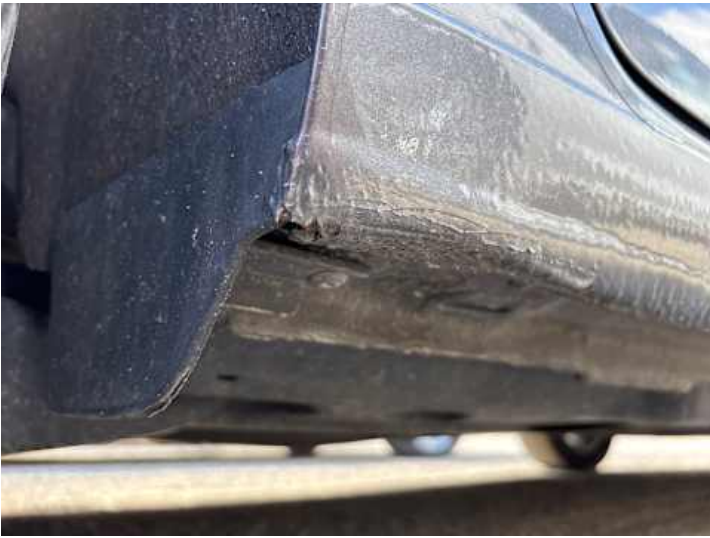
Schweller rechts (Riss/Bruch)
