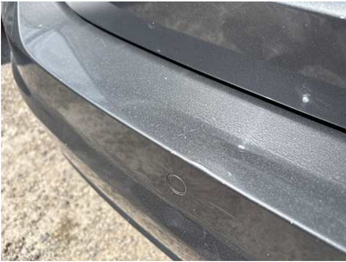
Stoßstange hinten (Verformung)
