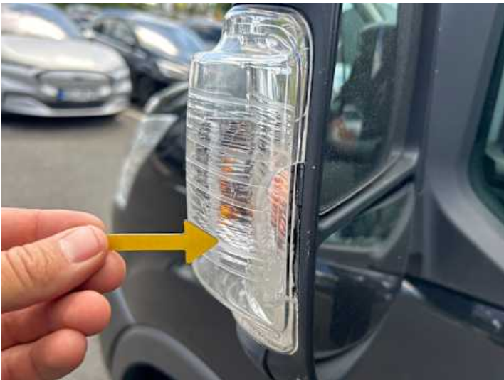
Fahrertür (Riss/Bruch, Kratzer)
