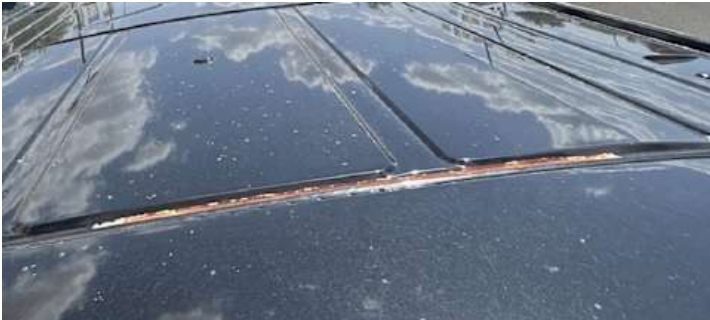
Dach (Rost, Kratzer)
