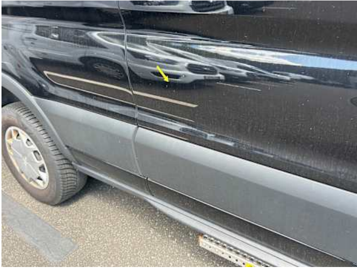
Türe hinten rechts (Delle, Kratzer)
