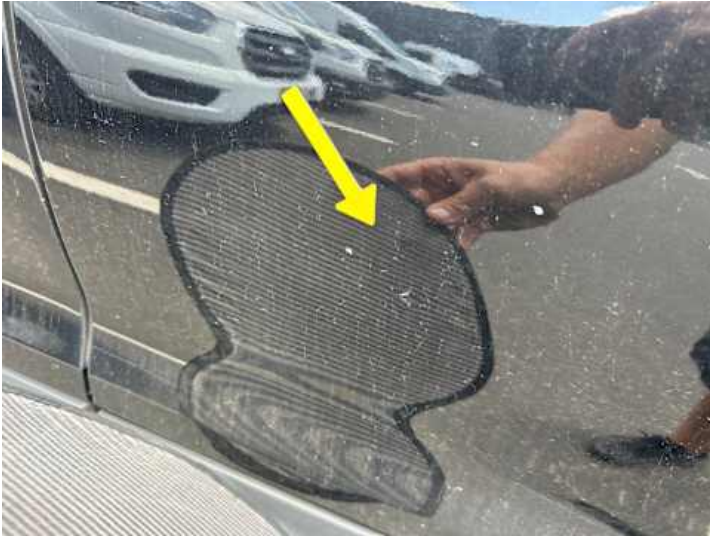
Türe hinten rechts (Delle, Kratzer)
