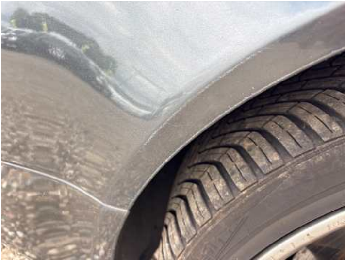
Kotflügel vorne links (Kratzer)
