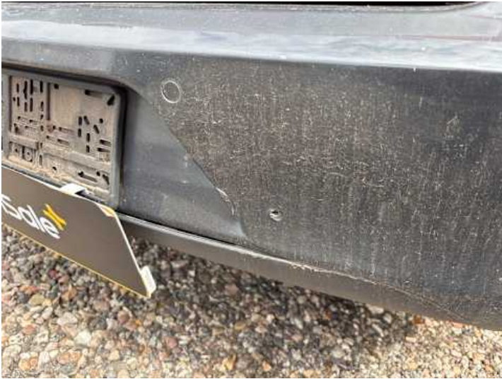
Stoßstange hinten (Spaltmaße ungenau, Kratzer)
