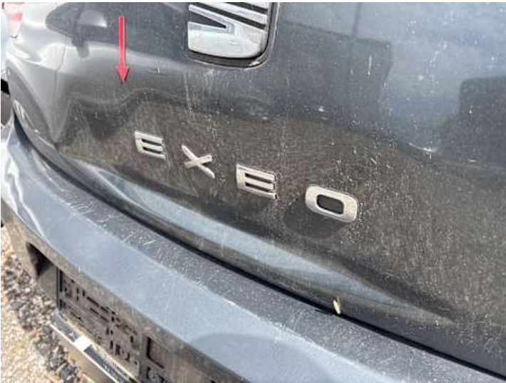
Heckklappe (Verformung, Kratzer)
