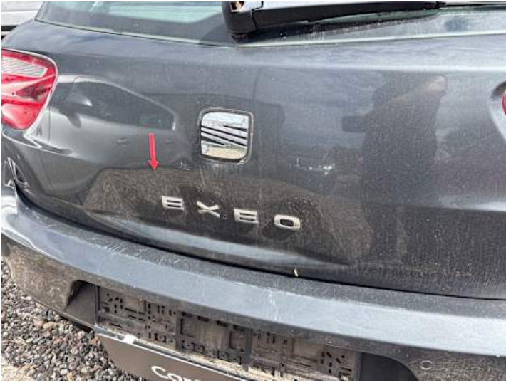
Heckklappe (Verformung, Kratzer)
