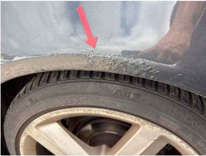
Seitenteil hinten links (Rost)
