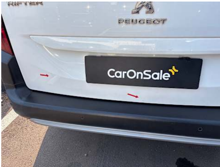
Heckklappe (Lackschaden, Kratzer)
