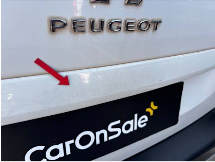
Heckklappe (Lackschaden, Kratzer)
