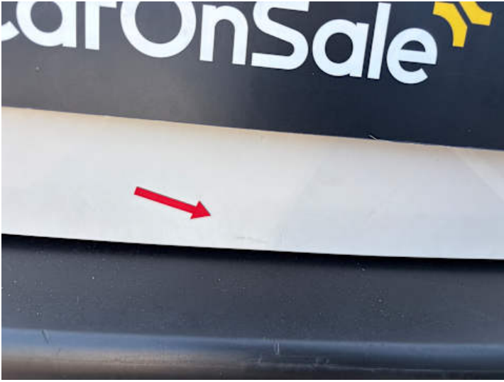
Heckklappe (Lackschaden, Kratzer)
