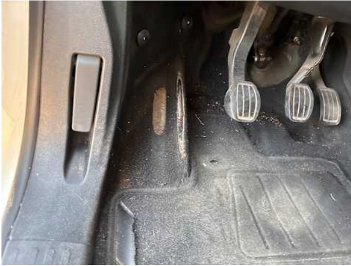
Innenraum (Verschleiß, Riss/Bruch)
