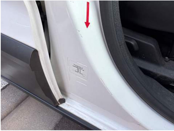
Schweller rechts (Lackschaden)
