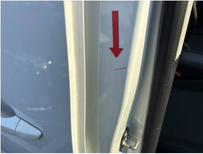
Schweller rechts (Lackschaden)
