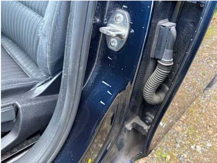
Schweller links (Kratzer, Delle)
