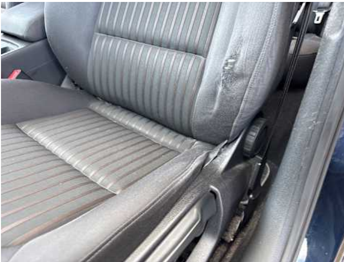
Innenraum (Verschleiß, Riss/Bruch)
