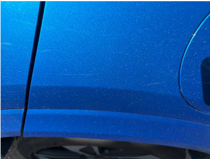
Seitenteil hinten links (Delle, Kratzer, Lackschaden)
