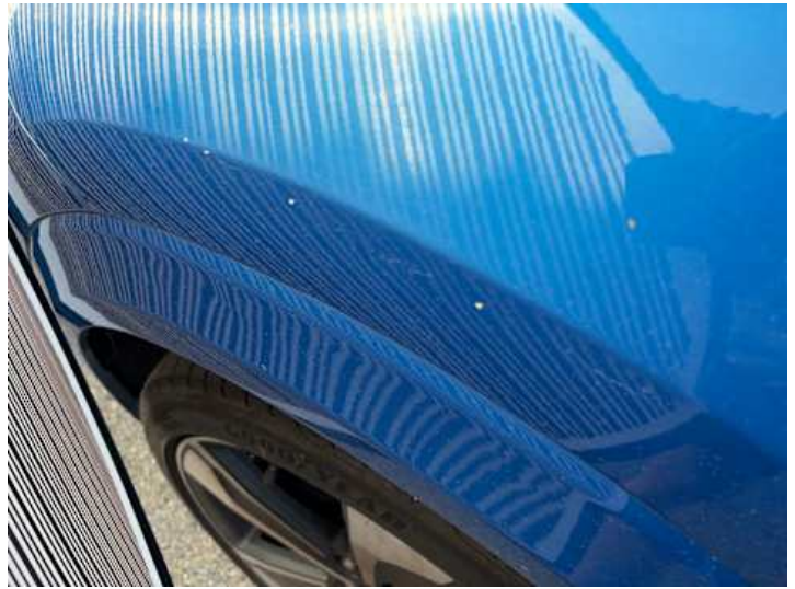
Kotflügel vorne links (Kratzer, Lackschaden, Delle)
