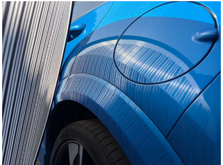
Seitenteil hinten links (Delle, Kratzer, Lackschaden)
