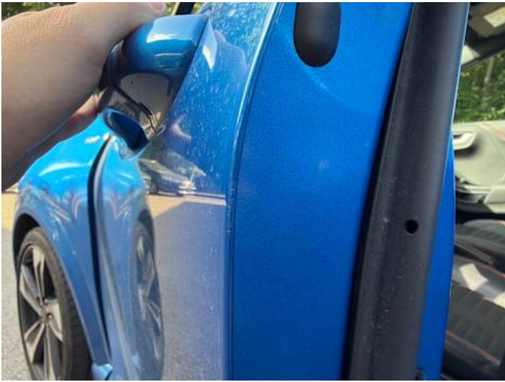
Fahrertür (Kratzer, Lackschaden)
