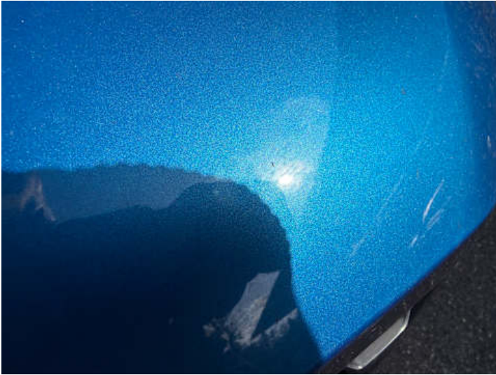
Stoßstange vorne (Steinschlag, Lackschaden)
