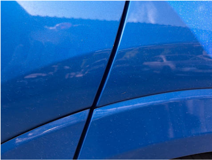
Türe hinten links (Kratzer, Lackschaden, Delle)
