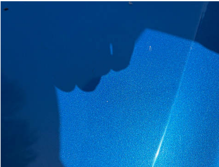
Motorhaube (Steinschlag, Lackschaden)
