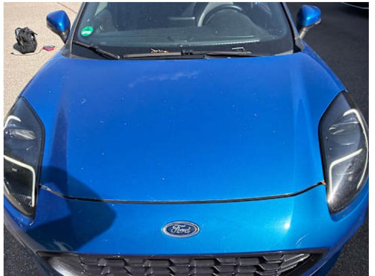
Motorhaube (Steinschlag, Lackschaden)
