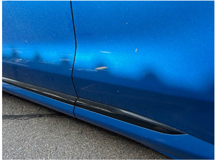
Türe hinten links (Kratzer, Lackschaden, Delle)
