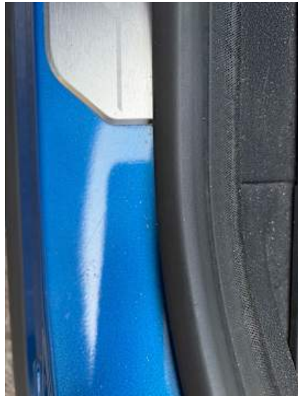
Fahrertür (Kratzer, Lackschaden)
