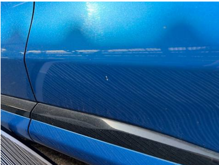
Türe hinten links (Kratzer, Lackschaden, Delle)
