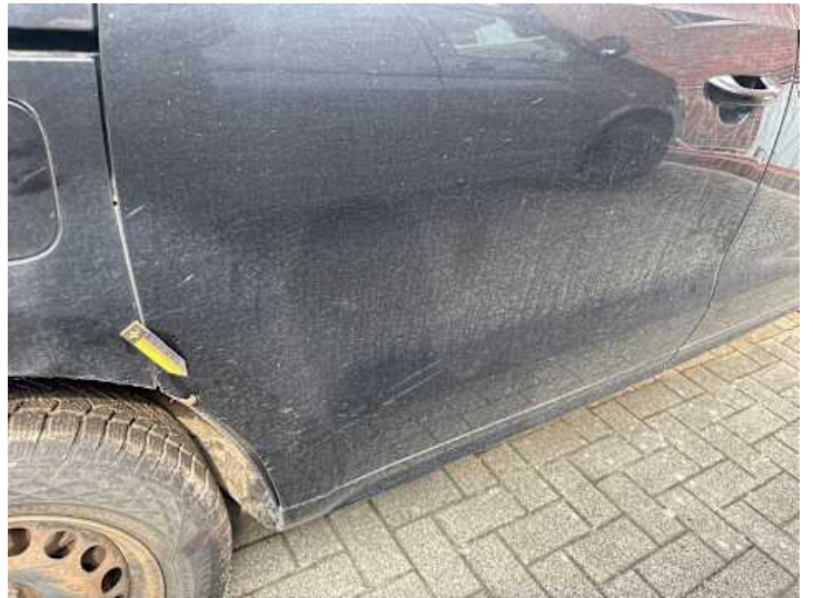
Türe hinten rechts (Rost, Lackschaden, Spaltmaße ungenau)
