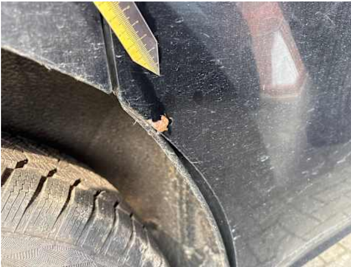
Türe hinten rechts (Rost, Lackschaden, Spaltmaße ungenau)
