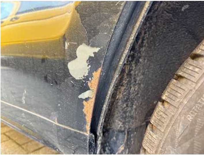
Türe hinten links (Rost, Lackschaden, Spaltmaße ungenau)
