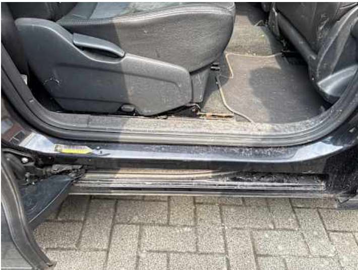
Schweller rechts (Kratzer, Delle)
