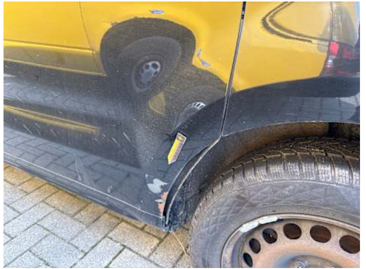
Türe hinten links (Rost, Lackschaden, Spaltmaße ungenau)
