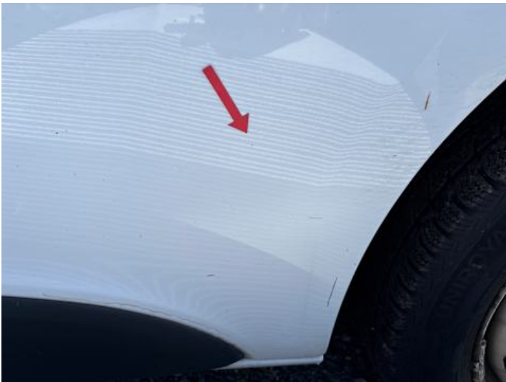
Beifahrtür (Kratzer, Delle)
