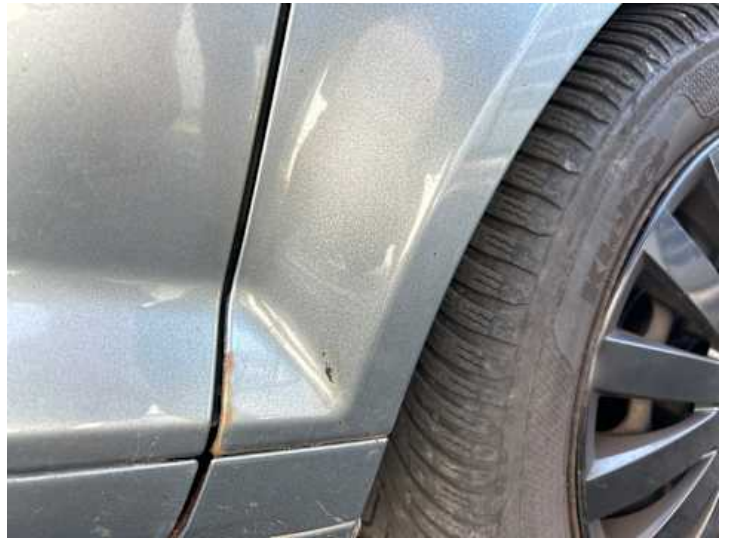
Kotflügel vorne rechts (Rost)
