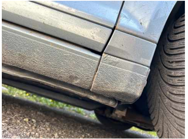
Schweller rechts (Rost)
