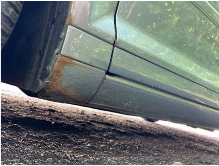
Schweller links (Rost)
