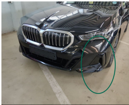
Stoßfänger / Vorne Links / Gebrochen
