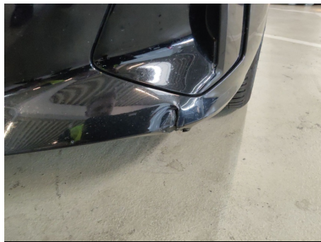
Stoßfänger / Vorne Links / Gebrochen
