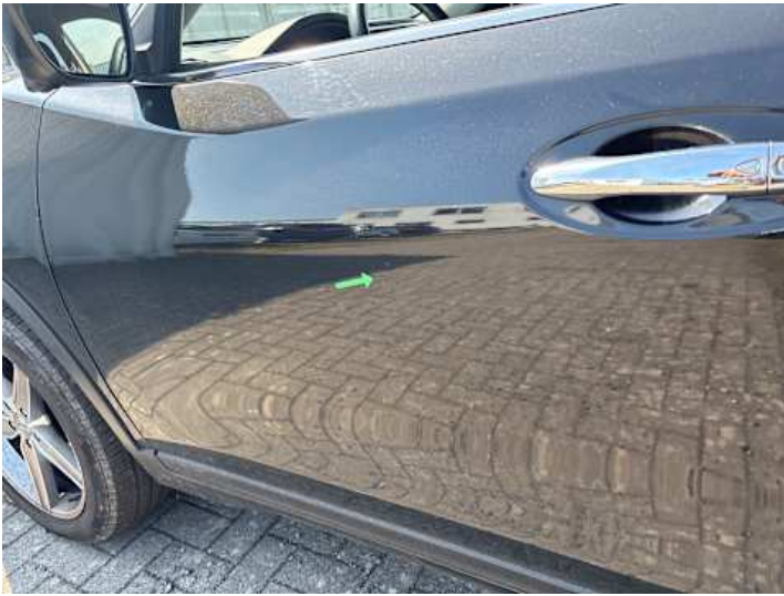
Fahrtür (Delle, Kratzer)
