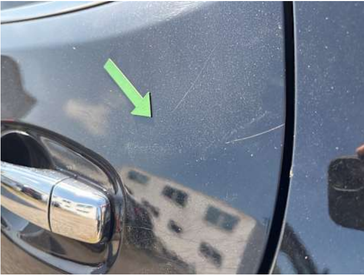
Türe hinten links (Kratzer)
