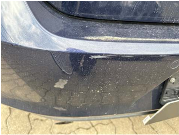
Stoßstange hinten (Kratzer, Spaltmaße ungenau)
