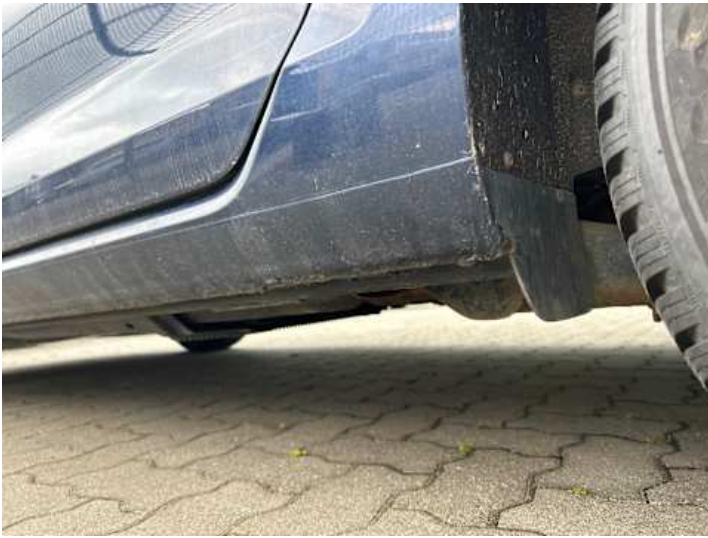
Schweller links (Verformung, Kratzer)
