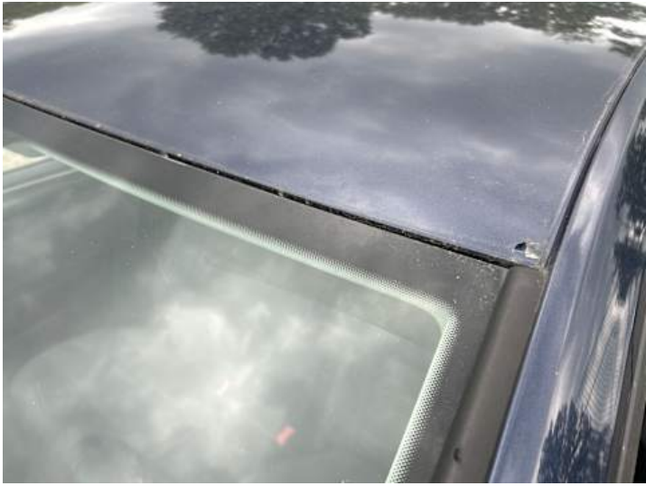
Dach (Lackschaden, Kratzer, Delle)
