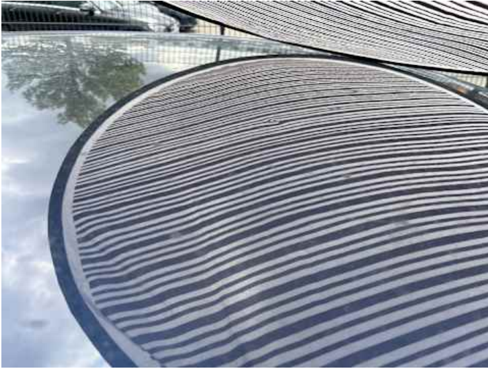
Dach (Lackschaden, Kratzer, Delle)
