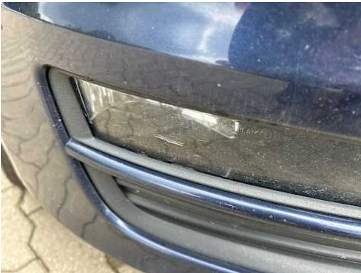
Scheinwerfer (rechts) (Riss/Bruch)
