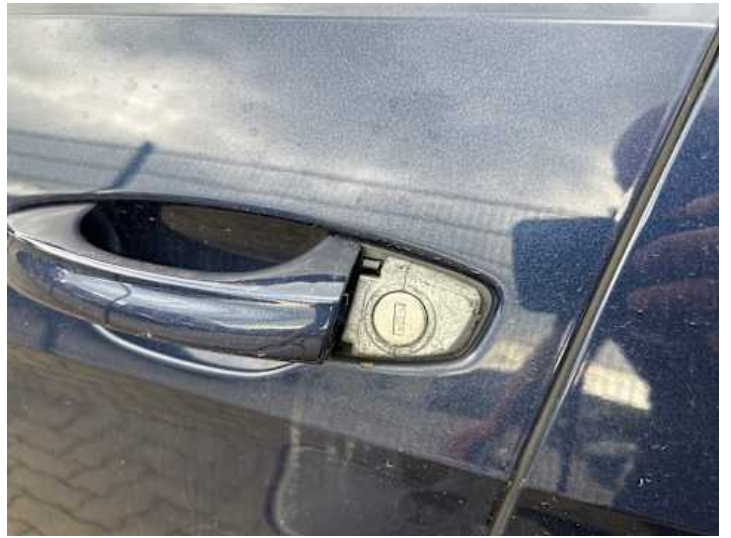
Fahrtür (Anderer Schaden, Kratzer): Abdeckung fehlt;
