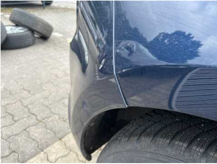
Stoßstange hinten (Kratzer, Spaltmaße ungenau)
