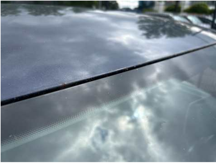
Dach (Lackschaden, Kratzer, Delle)
