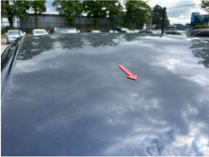
Dach (Lackschaden, Kratzer, Delle)
