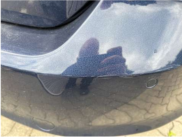
Stoßstange hinten (Kratzer, Spaltmaße ungenau)
