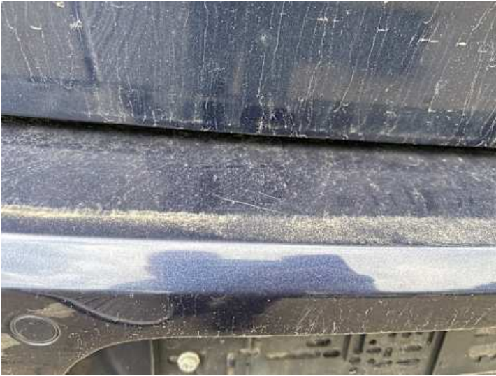
Stoßstange hinten (Kratzer, Spaltmaße ungenau)
