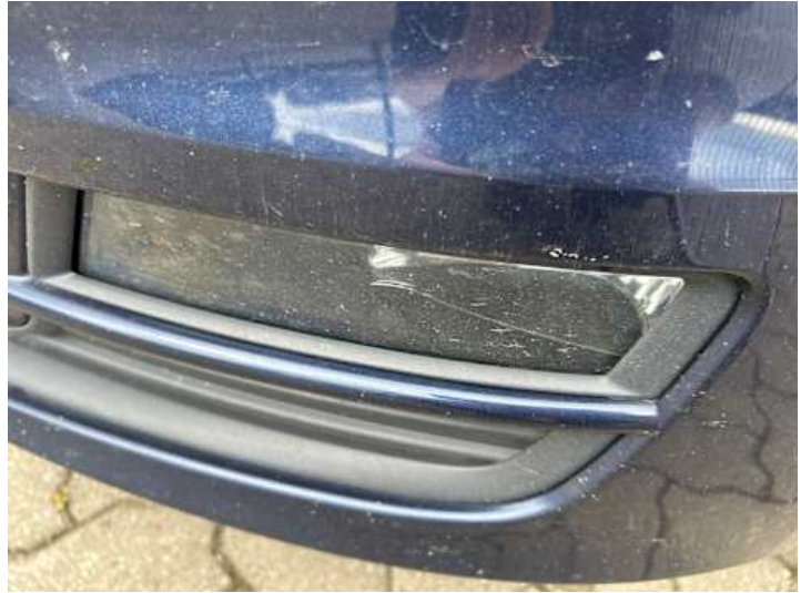
Scheinwerfer (links) (Riss/Bruch)
