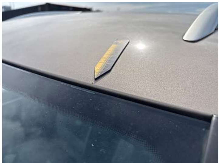
Dach (Steinschlag, Rost)
