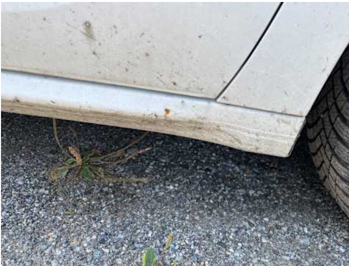
Schweller rechts (Rost)
