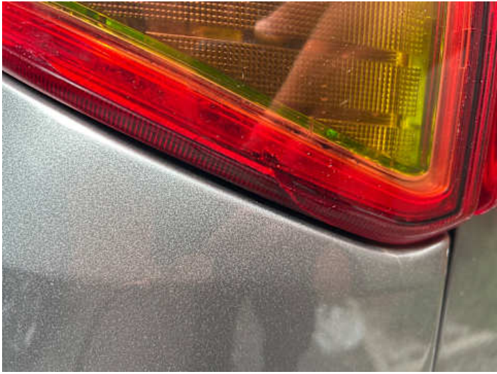
Rücklicht (links) (Riss/Bruch)
