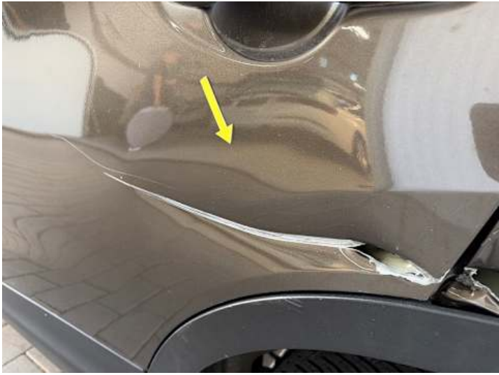
Türe hinten links (Riss/Bruch, Verformung)
