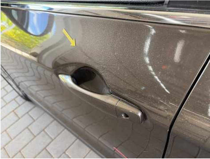
Fahrtür (Kratzer, Delle)
