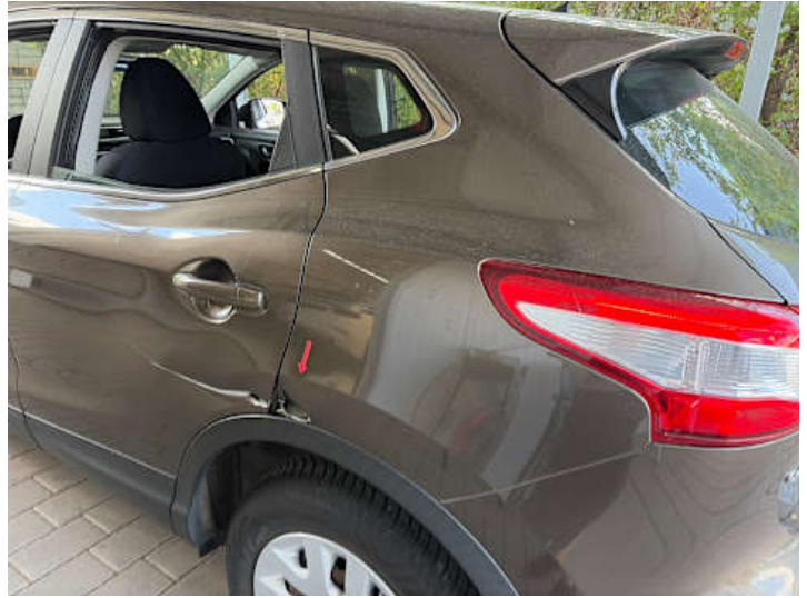
Seitenteil hinten links (Riss/Bruch, Verformung)
