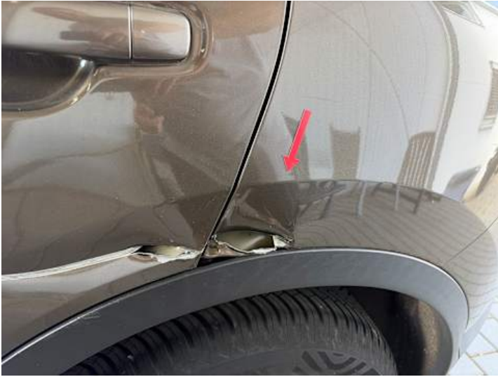
Seitenteil hinten links (Riss/Bruch, Verformung)
