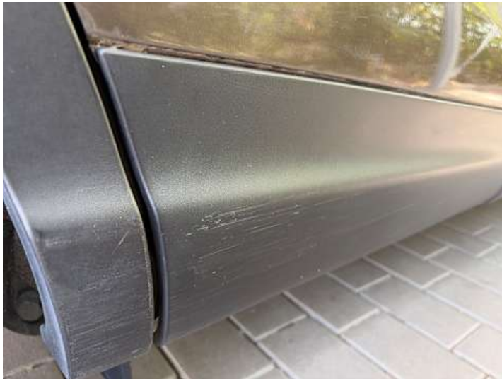
Türe hinten rechts (Kratzer, Delle)
