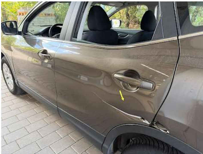
Türe hinten links (Riss/Bruch, Verformung)
