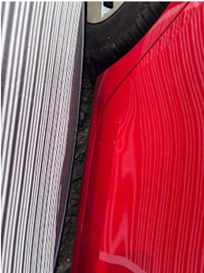
Türe hinten rechts (Delle)
