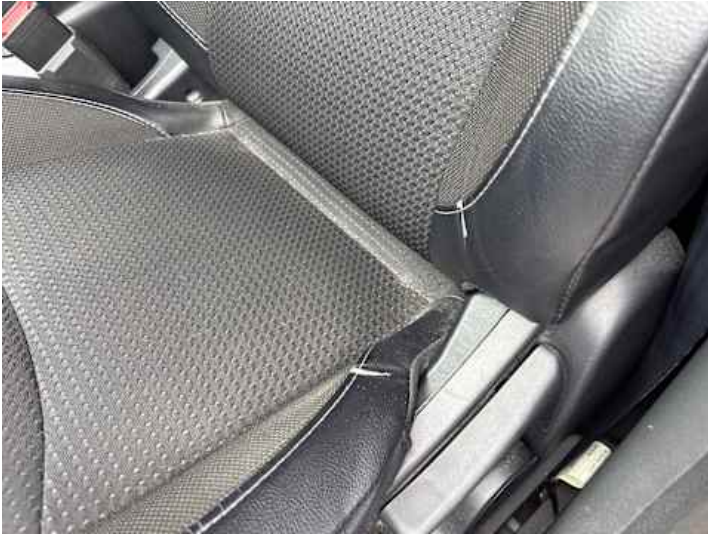
Innenraum (Riss/Bruch, Verschleiß, Kratzer)
