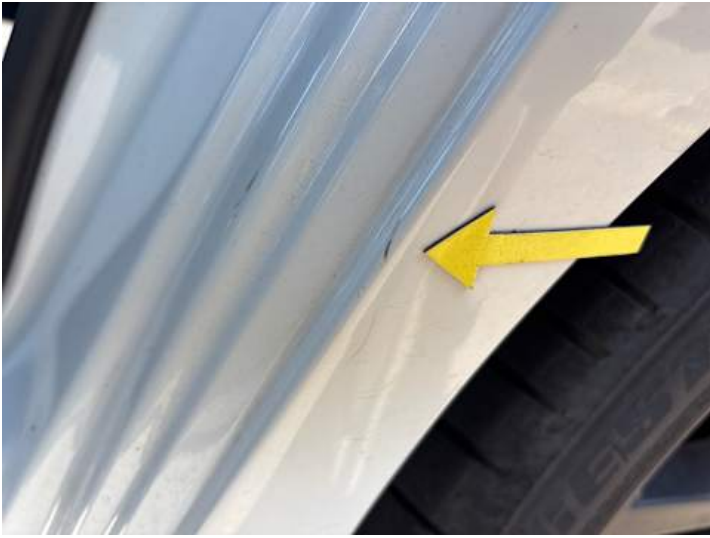
Seitenteil hinten links (Lackschaden)
