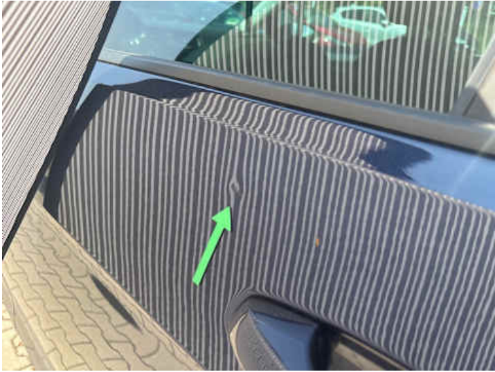
Türe hinten links (Delle)
