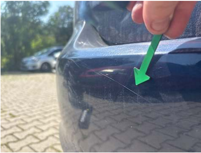
Stoßstange hinten (Kratzer)
