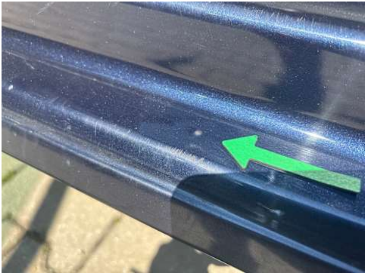
Schweller links (Kratzer, Rost)
