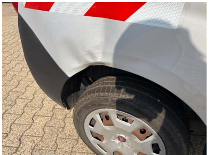
Seitenteil hinten rechts (Verformung)
