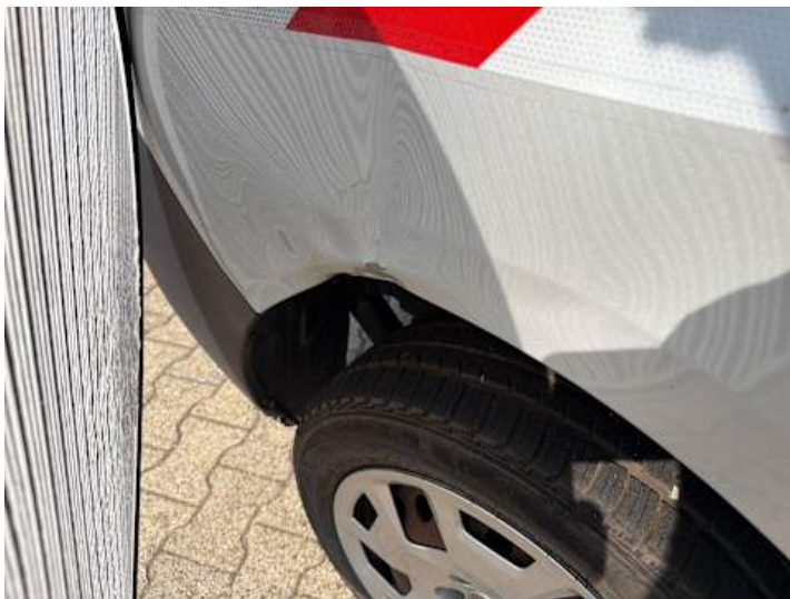
Seitenteil hinten rechts (Verformung)
