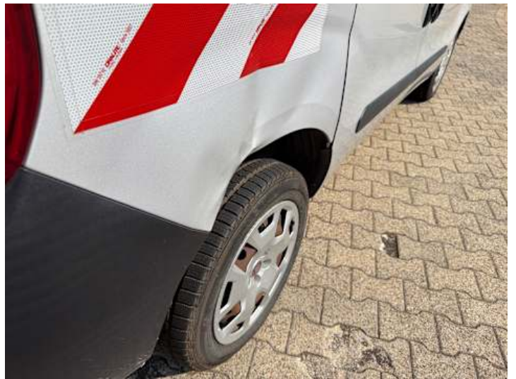
Seitenteil hinten rechts (Verformung)
