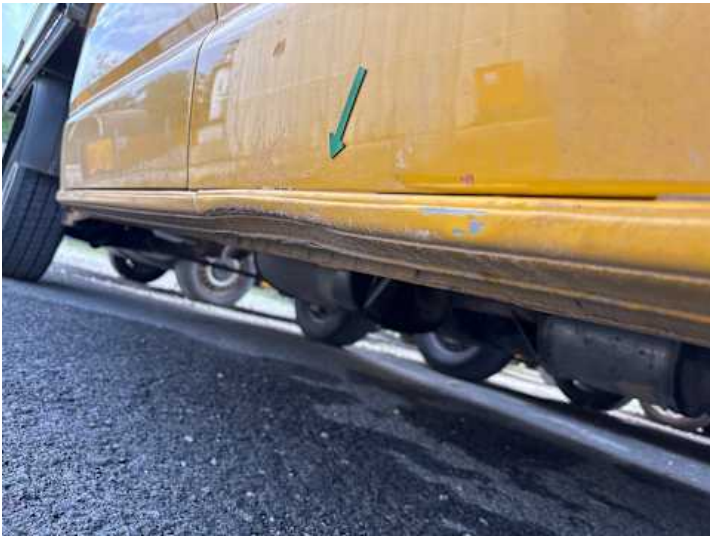
Schweller rechts (Kratzer, Verformung)
