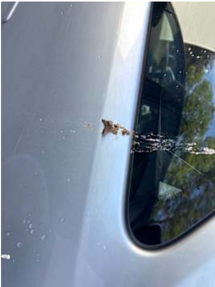
Seitenteil hinten links (Lackschaden)
