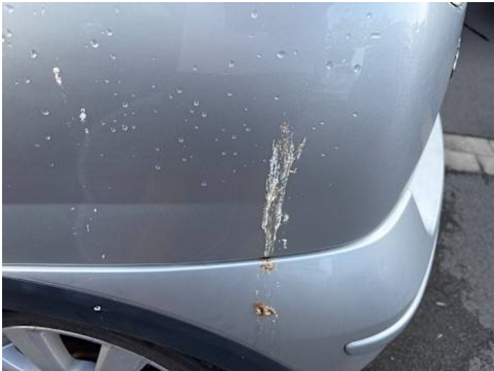
Seitenteil hinten links (Lackschaden)
