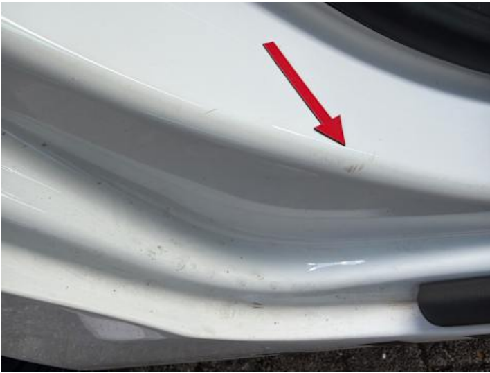
Schweller rechts (Kratzer)
