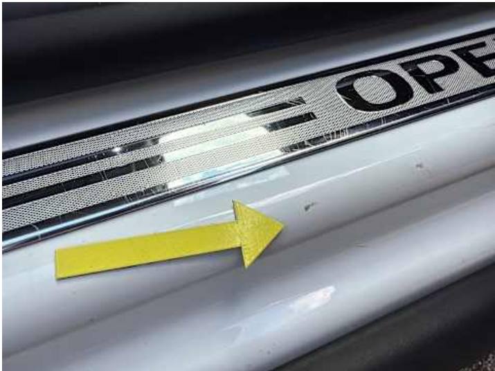
Schweller rechts (Kratzer)
