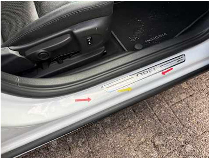
Schweller rechts (Kratzer)
