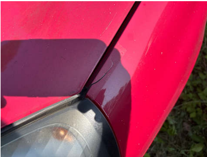
Kotflügel vorne links (Riss/Bruch)
