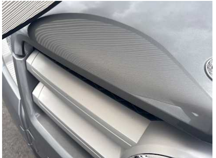
Motorhaube (Delle, Steinschlag)
