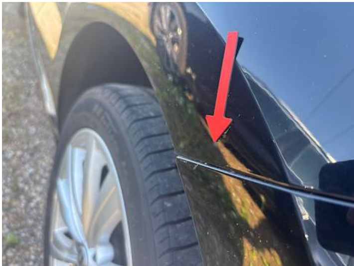
Seitenteil hinten links (Rost)
