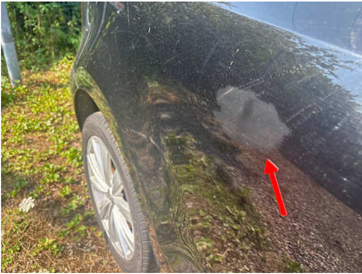
Seitenteil hinten rechts (Lackschaden)
