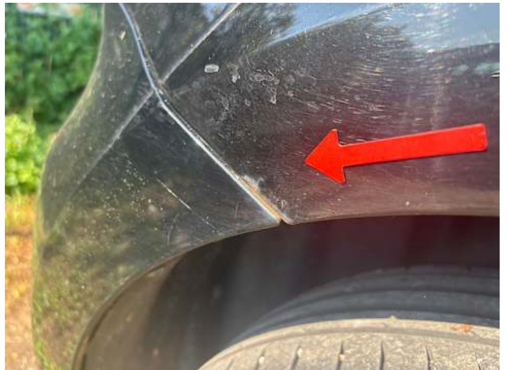
Seitenteil hinten rechts (Rost)
