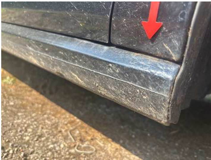
Schweller rechts (Rost)
