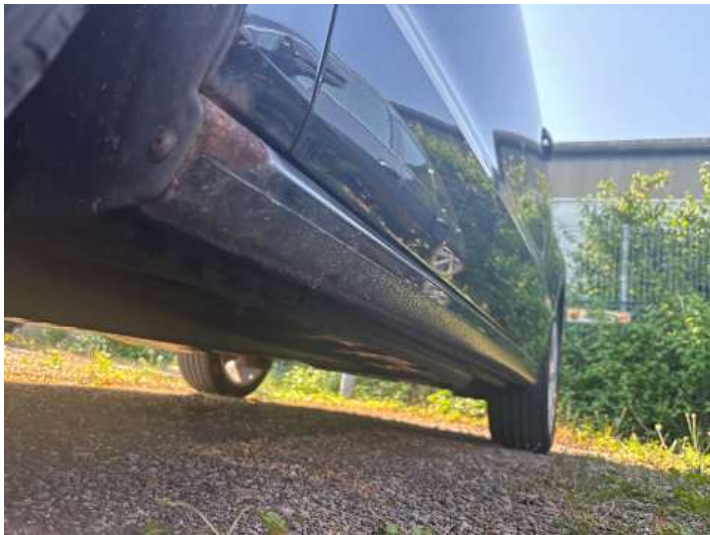
Schweller links (Rost, Verformung)
