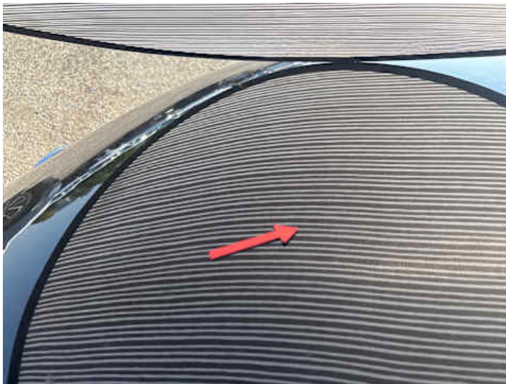
Motorhaube (Lackschaden, Unsachgemäß instand gesetzt)
