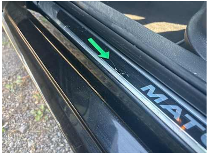
Schweller links (Kratzer, Delle, Lackschaden)
