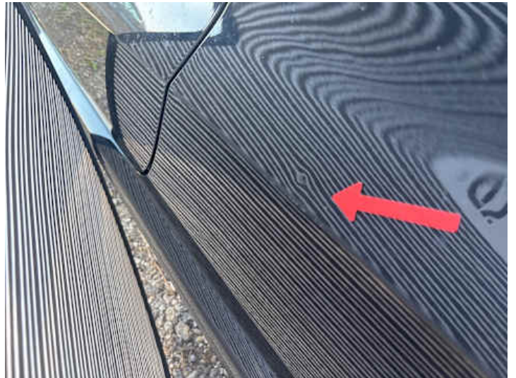
Seitenteil hinten links (Kratzer, Delle)
