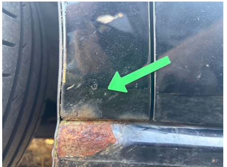
Kotflügel vorne links (Rost)
