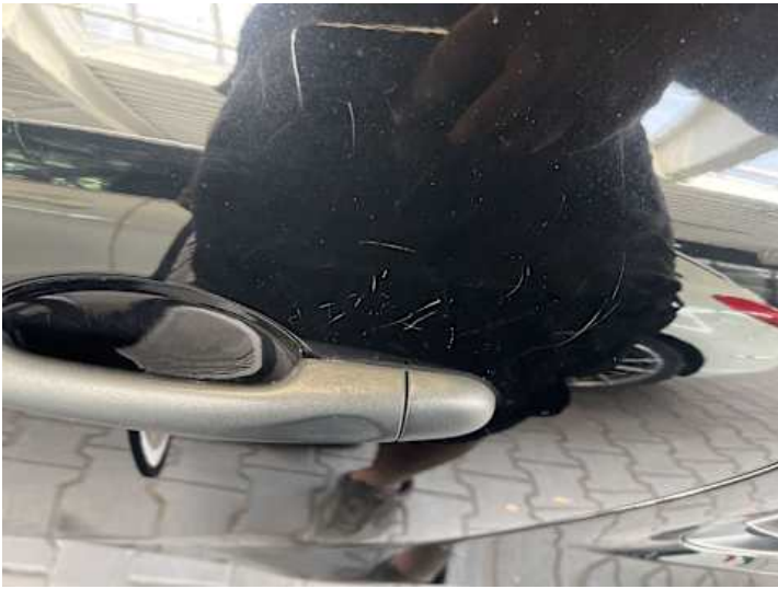
Türe hinten links (Kratzer, Lackschaden)
