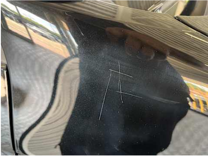
Kotflügel vorne rechts (Kratzer, Lackschaden)
