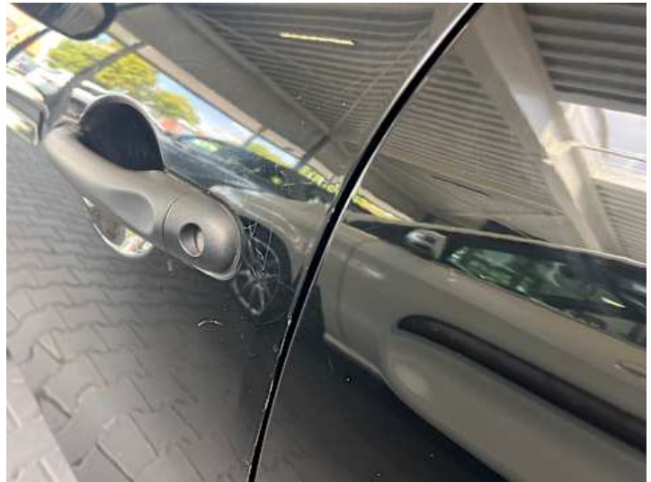
Fahrer ­ tür (Lackschaden)
