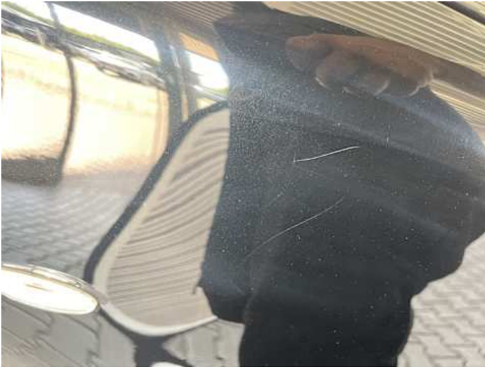
Kotflügel vorne rechts (Kratzer, Lackschaden)
