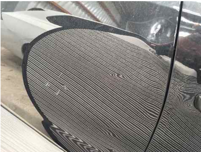
Türe hinten rechts (Verformung)
