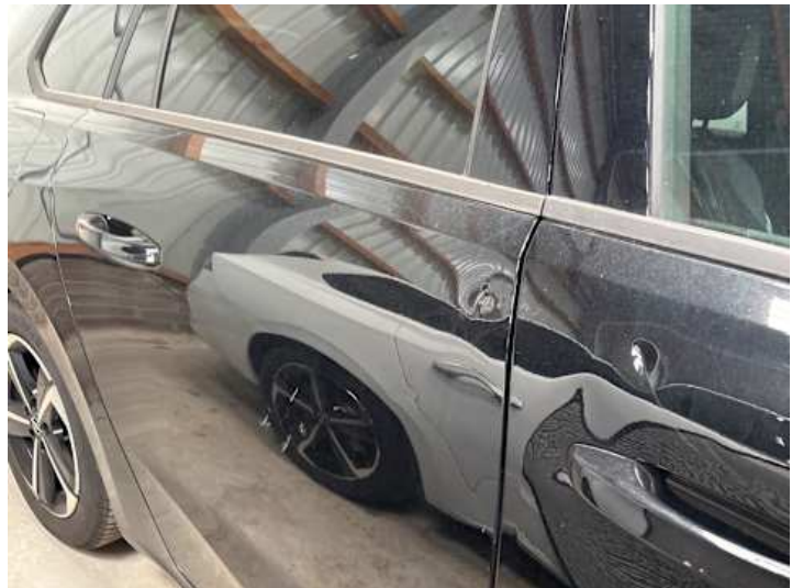
Türe hinten rechts (Verformung)
